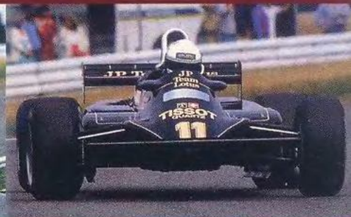
Теряя “граунд-эффект” на неровностях трассы, “автомобиль-крыло” становился неуправляемым
