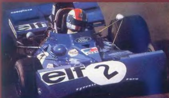
Массивный передний спойлер – "фирменная" черта Tyrrell
