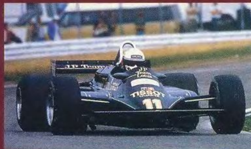
Теряя “граунд-эффект” на неровностях трассы, “автомобиль-крыло” становился неуправляемым
