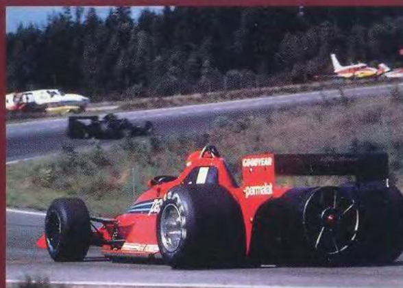
“Автомобиль-пылесос” Brabham BT46B
