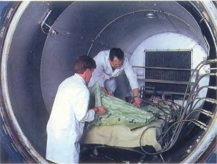
После обработки в автоклаве (слева), монокок подвергается внешней и внутренней отделке, которая производится вручную
