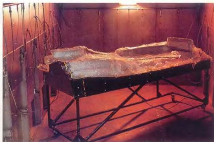
Заготовка детали углепластикового корпуса формируется в вакуумном мешке
