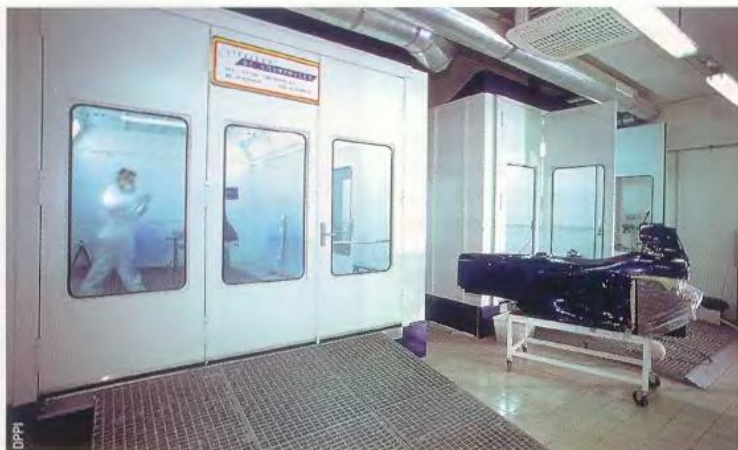
Пропеченный в автоклаве и прошедший этап отделочной обработки монокок ждет своей очереди в покрасочную камеру
