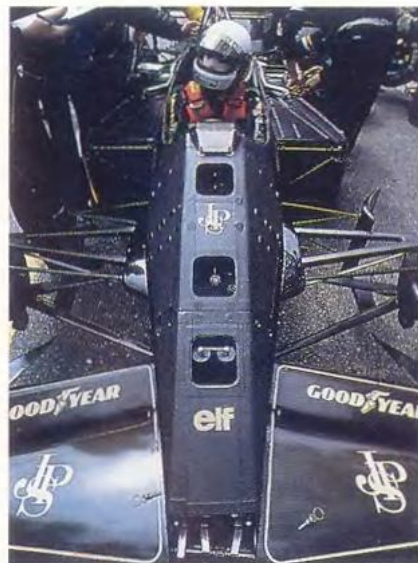
Первые углепластиковые монококи появились в начале 80-х. Слева: McLaren MP4/1E, 1983 г. Справа: Lotus 97T, 1985 г.
