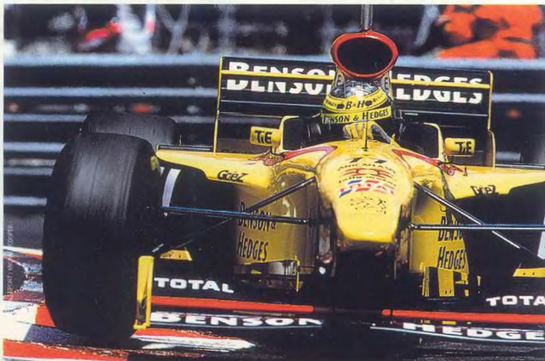
Уплощенные в сечении верхние воздухозаборники — еще одна «фирменная» черта конструкции Гари Андерсона
