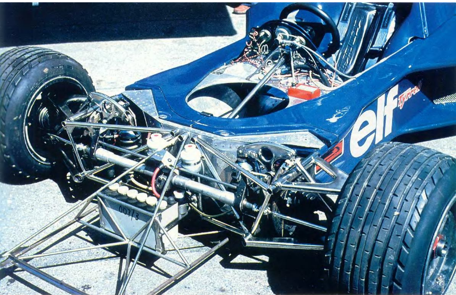
Передняя подвеска Tyrrell образца 1974 г.
