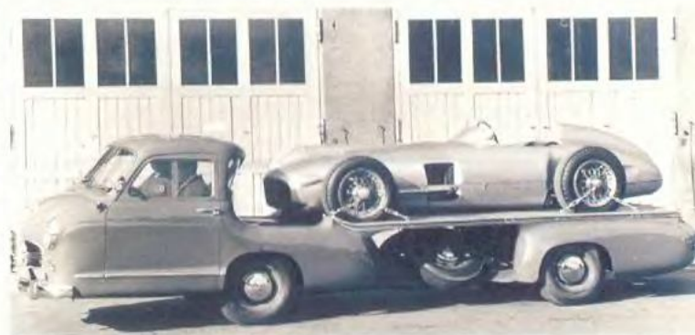
Конструкторы Mercedes-Benz создали специальный грузовик с трехлитровым гоночным двигателем для экстренной доставки машин к месту проведения гонок. Он развивал скорость до 160 км/ч
