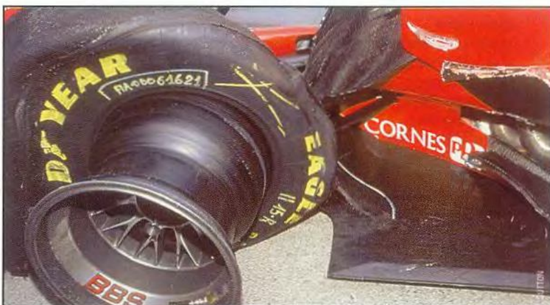
В конце 60-х для того, чтобы покрышка не соскочила с обода, ее начали крепить болтами. Впоследствии, когда «формулы» стали буквально стелиться по асфальту, от этого отказались. Но теперь прокол шины почти наверняка лишает пилота шансов на очки
