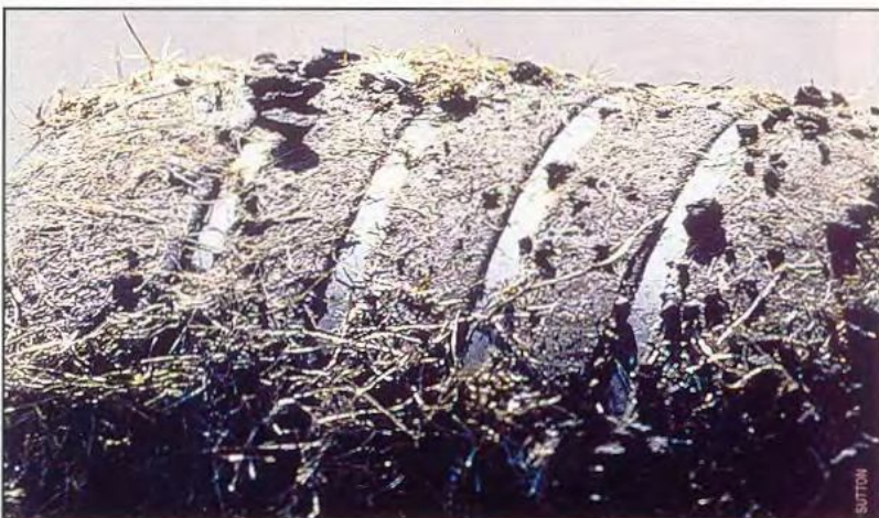
Вот что может случиться с современной сверхмягкой шиной – она притягивает грязь как магнит и стирается при неосторожном обращении не хуже пластилина
