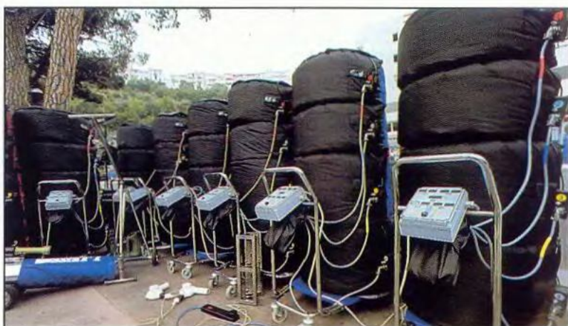
Раньше пилоты стартовали на холодных шинах. При разогреве в ходе гонки давление воздуха внутри увеличивалось, что приводило порой к самым неприятным последствиям. В 1987 году появились «электрогрелки» – специальные чехлы, позволявшие устанавливать нужную температуру (а значит, и давление) уже в боксах
