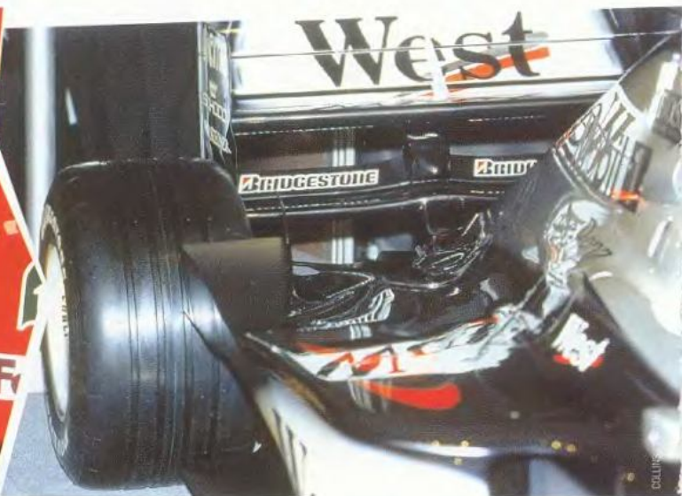
Дефлекторы у задних колес и сложный профиль нижней части боковых понтонов навеяны конструкторам Ferrari обводами чемпионского McLaren
