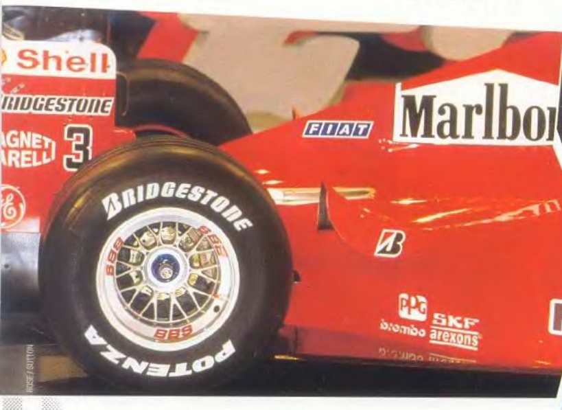
Дефлекторы у задних колес и сложный профиль нижней части боковых понтонов навеяны конструкторам Ferrari обводами чемпионского McLaren
