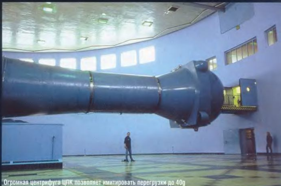
Огромная центрифуга ЦПК позволяет имитировать перегрузки до 40g
