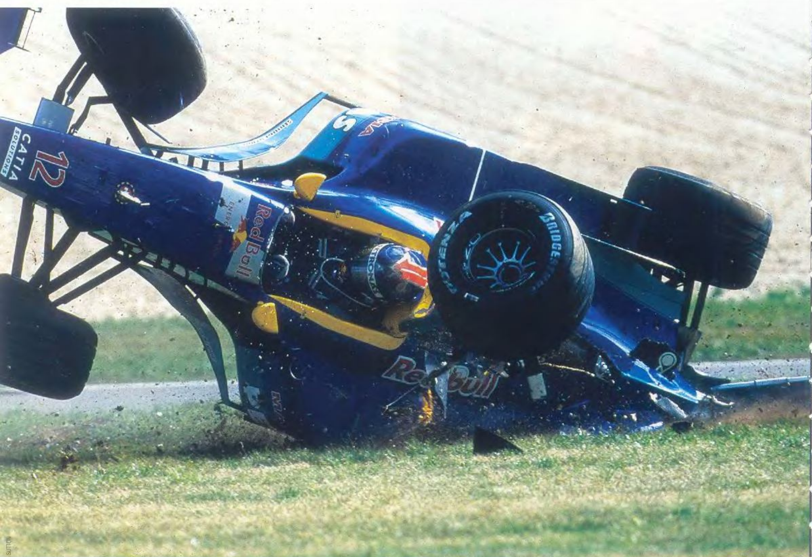
Редкий случай, когда от удара частично разрушился прочнейший углепластиковый монокок "формулы"
