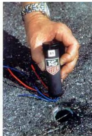
Так выглядит датчик, с помощью которого фиксируется фальстарт и засекается время дозаправки
