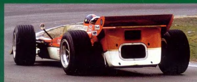
Еще одна неудача Чампена и его команды - газотурбинный Lotus 56 - тем не менее, поразила автогоночный мир клиновидным кузовом
