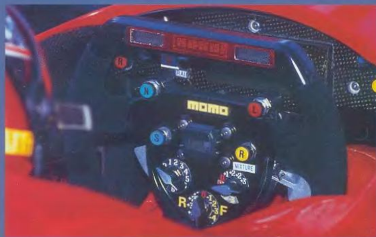
Ручка регулятора тормозного усилия "вперед-назад" расположена на рулевом колесе Ferrari F300
