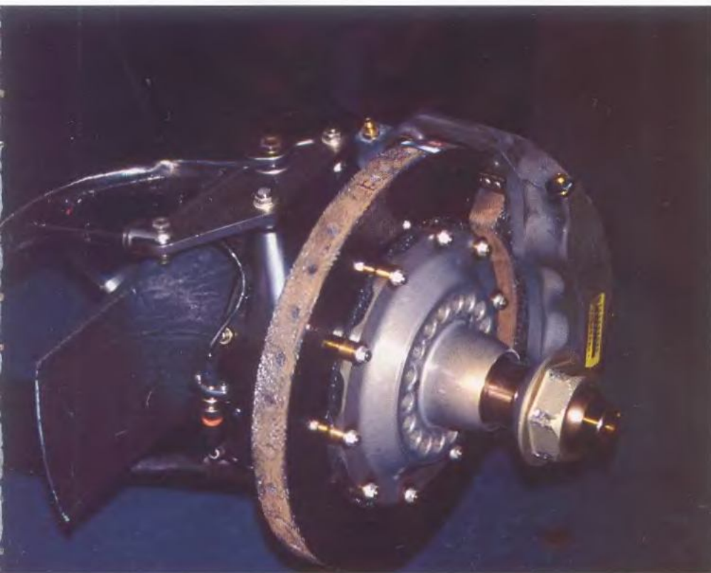
В 1998 году толщину дисков ограничили 28-ю мм, количество поршнейков – 6-ю, а накладок – 2-мя. На снимке переднего тормоза McLaren хорошо видны изготовленная из алюминия с добавлением лития скоба и воздухозаборник для охлаждения
