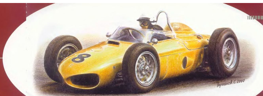
“Дино-156” редчайшей канареечно-желтой масти принадлежал “Национальной бельгийской команде”, за которую в 1961 году выступал Оливье Жювье. Отличить старый мотор с углом развала 65° можно по высокой решетке над воздухозаборниками карбюраторов. У машины с двигателем 120° их было две – и более низкие
