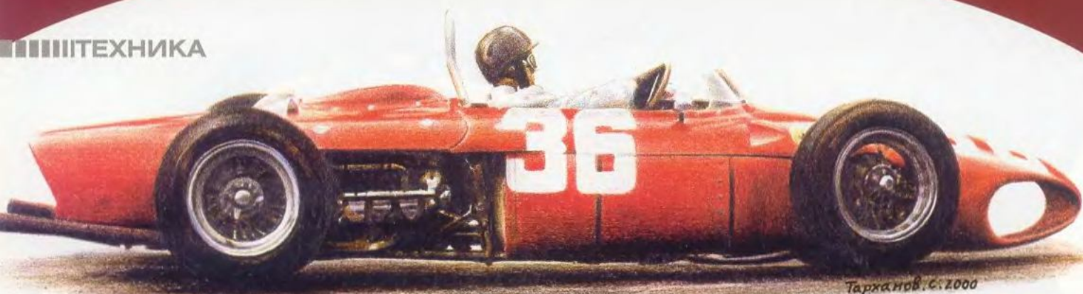
Первый вариант "Дино-156" с удлиняющей кормой и коротким ветровым стеклом для Гран При Монако
