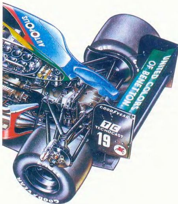
На Benetton 190 1990 года коробка передач для уменьшения полярного момента инерции автомобиля размещена между двигателем и главной передачей. Рычаги и пружины задней подвески крепятся к картеру коробки, которая является несущим элементом конструкции
