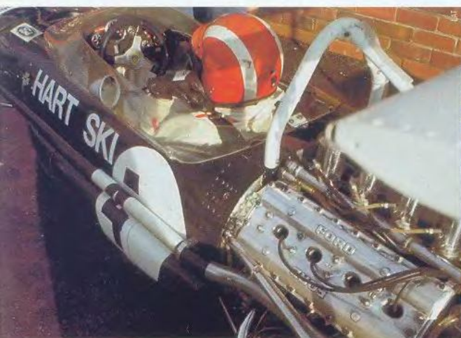
Brabham BT26, как и большинство автомобилей Ф-1 в 1969 году, был оснащен двигателем Ford-Cosworth
