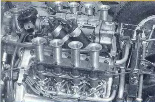
1,5-литровый 8-цилиндровый двигатель Ferrari с непосредственным впрыском
