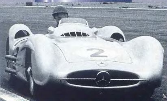
W196 не только выглядел фантастически, но и обладал передовой для своего времени "начинкой": двигателем с непосредственным впрыском
