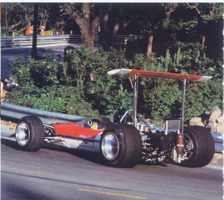
Brabham BT26, как и большинство автомобилей Ф-1 в 1969 году, был оснащен двигателем Ford-Cosworth
