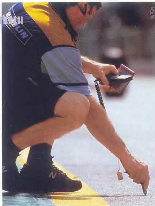
Техник Michelin измеряет температуру асфальта. Накал "шинной войны" измерить не так просто
