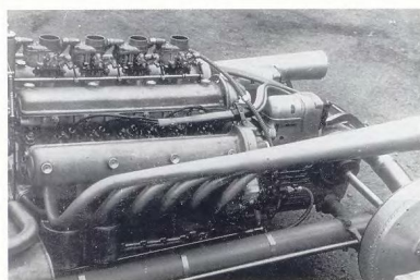
12-цилиндровый 2-литровый мотор с четырьмя карбюраторами и двумя магнето. Видны труба моста де Дюна, задняя часть одного из двух боковых топливных баков и две клапанные крышки левого ряда цилиндров
