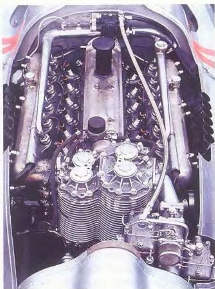
12-цилиндровый мотор (Typ D) 1938 года при рабочем объеме 3 литра развивал мощность 485 л.с. Он был оснащен двумя нагнетателями, которые работали последовательно
