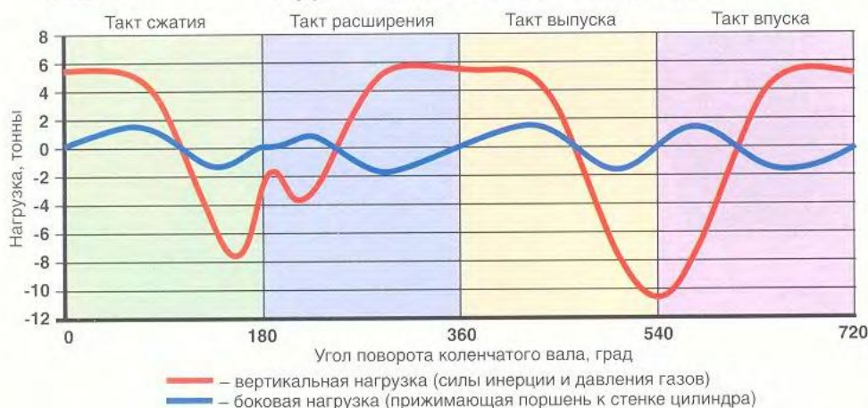
Рис. 1 Нагрузки, действующие на поршень
