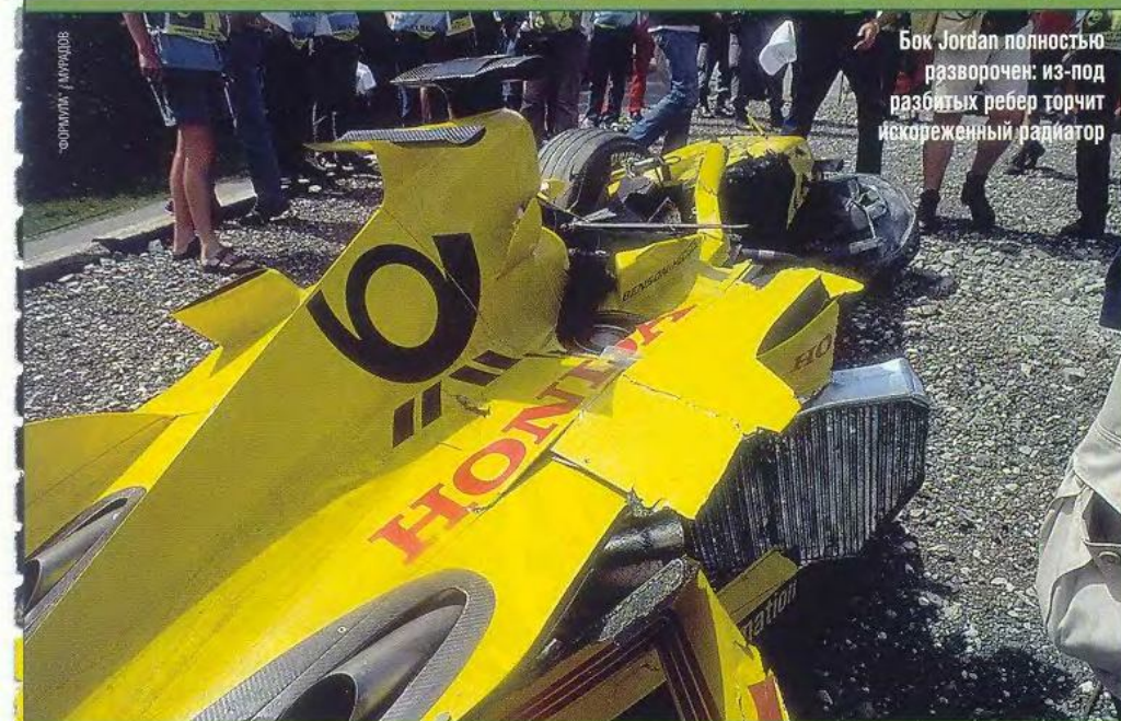
Сверхпрочный монокок не выдержал удара, но жизнь и здоровье гонщику спас
