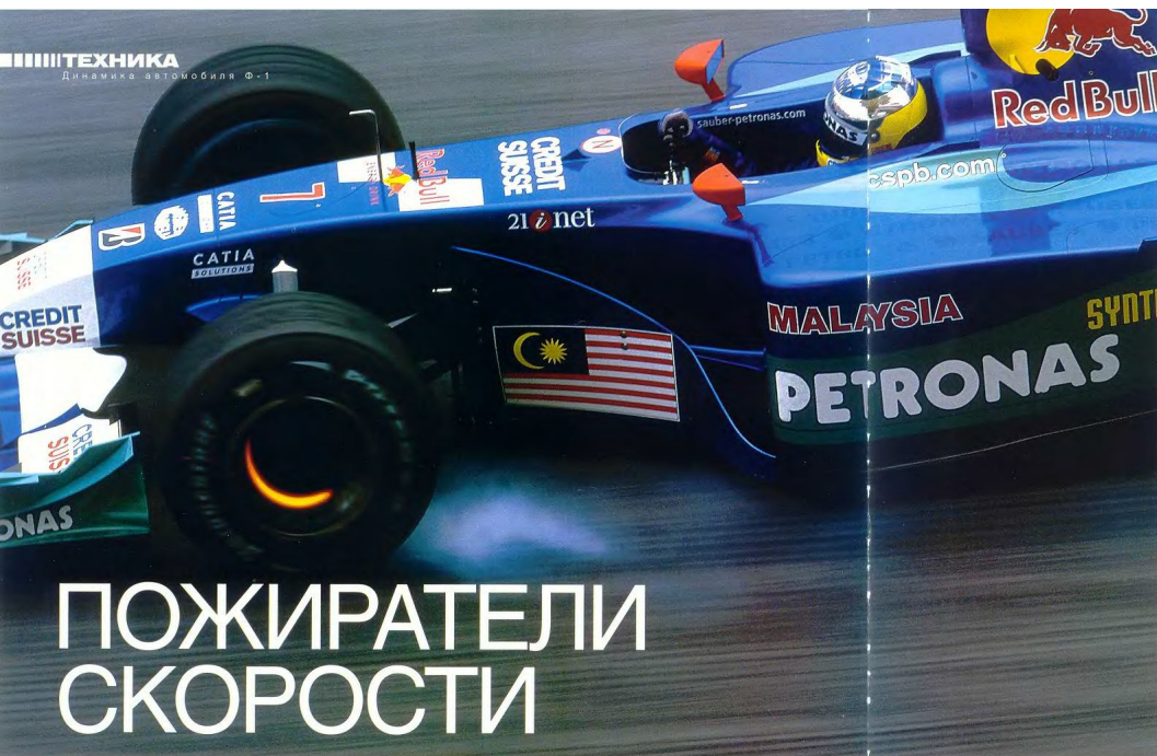
Тормозной узел кабриолет по размерам, но весьма "живучий" и способен за считанные метры поглотить энергию, которую 600-килограммовый автомобиль накопил при разгоне
