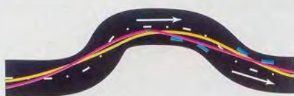
Рис. 5. Траектории прохождения "эски" — быстрый выход из "эски" — плавное изменение кривизны
