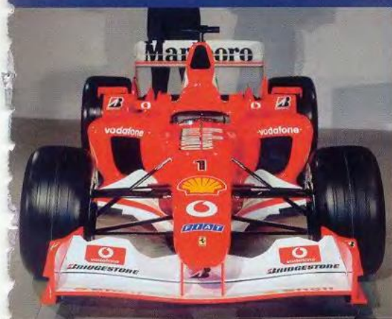
Нижний край боковых дефлекторов, с которыми у Ferrari были проблемы в 1999 году, получил необычную "зубастую" форму
