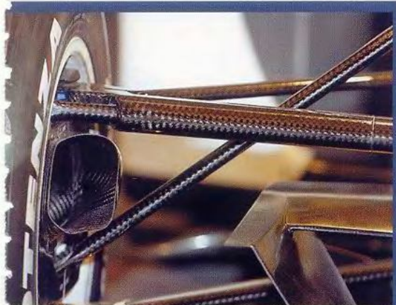
Крепление дефлектора, "вписанного" в переплетение рычагов передней подвески, выполнено в виде мини-антикрыла
