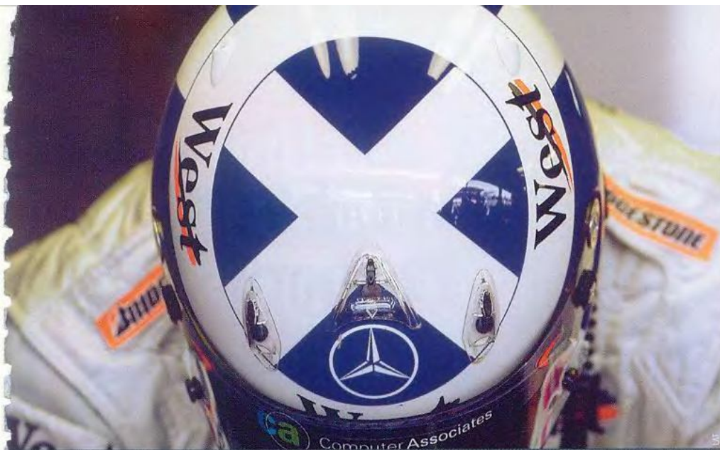
На этом снимке можно рассмотреть выходные вентиляционные отверстия шлема. Дэвид Култхард, квалификация ГП Германии, Хоккенхайм, 28 июля 2001 года
