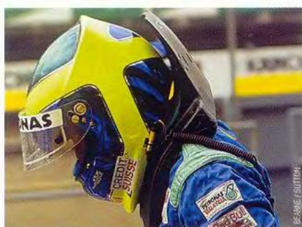
ГП Италии, Монца, 2002 год. Не дожидаясь начала нового сезона, в котором применение HANS становится обязательным, гонщики Sauber испытали устройство непосредственно в гонке уже в конце сезона прошлого
