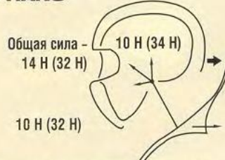
Нагрузки на шею при торможении 40g (В скобках - порог травмирования)
