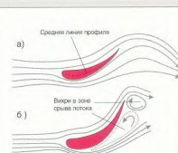
Рис. 2. Антикрылья с изогнутой средней линией (хордой)
