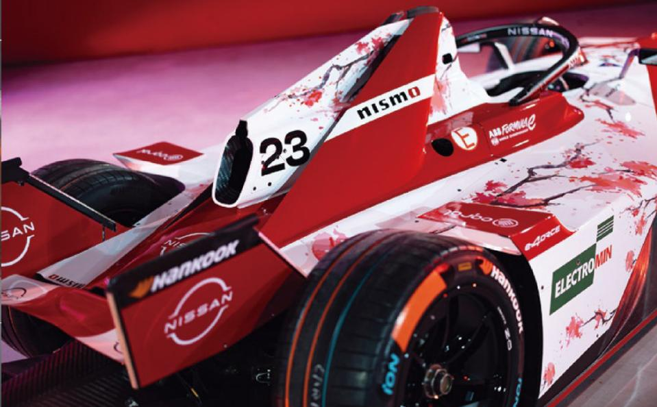
GEN3ではノーズ先端からサイドポンツーンにかけての部分が庇のように張り出しており、上面視すると広角の三角形になっていた。GEN3 Evoではノーズ先端～サイドポンツーンをシャープなラインでつないでいる。フロントウイングは形だけで、ダウンフォース発生装置としての役割はほとんど果たしていない。リヤのフィンも同様。
