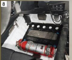
**1** 日本仕様には設定されていない最高出力204psの2.8ℓ 1GD型4気筒ディーゼルトターボエンジンを搭載。逆輸入車のため車検証の型式は不明と記載される。トランスミッションは6ATとなる。**2** フロントダンパーはクスコが4×4用に開発した3WAYサブタンク式ツインダンパーの試作品を搭載。リヤも同じくクスコ製の試作品。**4** ロールオーバーはセーフティ21の6点式をベースとした11点式タイプを装備。**5** 純正のステアリングスイッチはクスコが試作した移植キットに移設。**6** シートは左右ともブリッド製XERO CS 8 (フルカーボン) に換装。**7** 広い荷室には2本のスペアタイヤと油圧式ジャッキを搭載。**8** 運転席足元のヒールプレートには消火器をセットしている。
