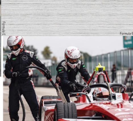
新たな注目ポイントとなりそうな充電ピットストップ、通称ピットブースト（写真はレース中ではなく事前テスト時）。カウル尾部に備わる充電コネクタを通じ30秒の停止時間で3.85kWを“チャージ”することが可能になった。（as）
