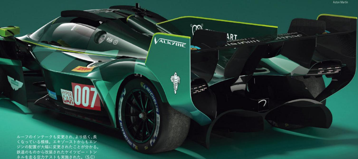
ルーフのインターイクも変更され、より低く、長くなっている模様。エキゾーストからもエンジンの配置が大幅に変更されたことが分かる。鉄道のものから改装されたケイツビー・トンネルを走る空力テストも実施された。(S.C)
