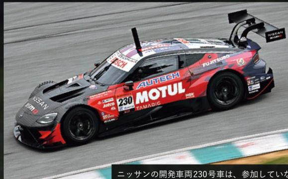
ニッサンの開発車両230号車は、参加していない23号車のふたりが走らせた。ルーフには対気速度を計測するピトー管を装着。230号車はカーボン地とカラーリングされたボンネットの2種類を試す姿が目撃されており、エンジンルーム内のダクトなど、開発が認められた部分のテストをしていたのかもしれない。
