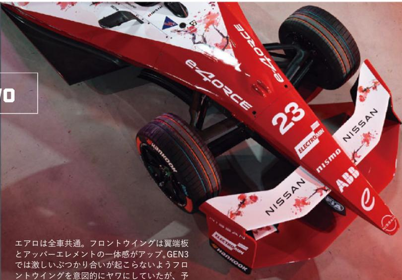
エアロは全車共通。フロントウイングは翼端板とアッパーエレメントの一体感がアップ。GEN3では激しいぶつかり合いが起こらないようフロントウイングを意図的にヤワにしていたが、予想以上に壊れやすかったためEvoでは強化。リヤタイヤ前にウイングレットを追加。
