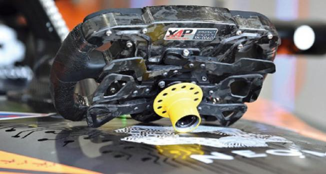
上下ウイッシュボーンのあいだにシュラウドに覆われたドライブシャフトが通る。高速域/低速域の伸び側/縮み側の減衰力を調節できるダンパーは共通部品で、フロント、リヤともにZF製。ステアリングのパドル（片側各3つ）はカスタマイズ可能で、マップ切り替え、アタックモードのアクティベート、回生などを割り当てる（写真は左が23-24シーズンのマクラーレン、下が同シーズンのジャガー）。
