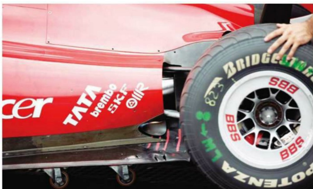
Rd.11 Germany 導入緒戦のパレンシアでの仕様はテールパイプの開口も単純に円形で、ほぼ真っ直ぐ後方に抜かれていた。ここドイツでの進化型バージョンは開口が外に向けられ、3Dのカットが施されている。
