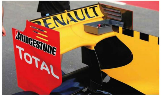
Rd.10 Great Britain F30スタンダードとも言えるリヤウイング。1本のセンターステーを中心として、左右がいったん持ち上がり翼端板に向けて下げられる。ロウウイングのサブエレメントは装備されていない。
