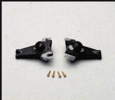
アップライトとサスアームの連結部分は、その外側に0.3mm厚のプラ板を接着し、実車同様にアームを前後から挟み込むような構造とした。しかし、その後のアライメント調整が難しくなってしまうので、あまりおすすめできない。
