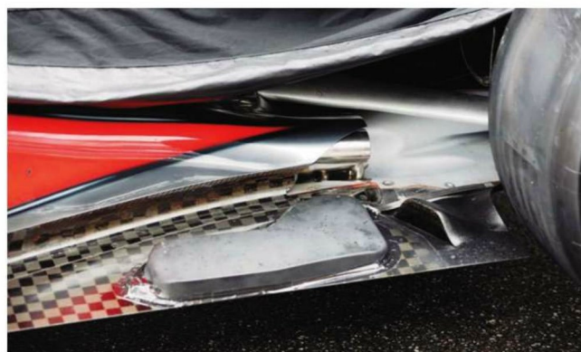
Rd.11 Germany セッション開始前の車検時点では、前戦シルバーストンそのままのブロウンディフューザー処理。エキゾーストのテールパイプは円形で、斜めにカットされたカウルが上部だけを覆っている。
