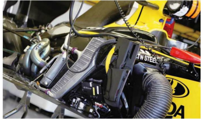
Rd.9 Europe エンジン冷却系はラジエーターパネルが前方の大型と、後部小型とに分かれる。位置関係からすると、冷却風が流れる径路も異なるようだ。サイドポンツーンコンパクト化にもつながるのかもしれない。
