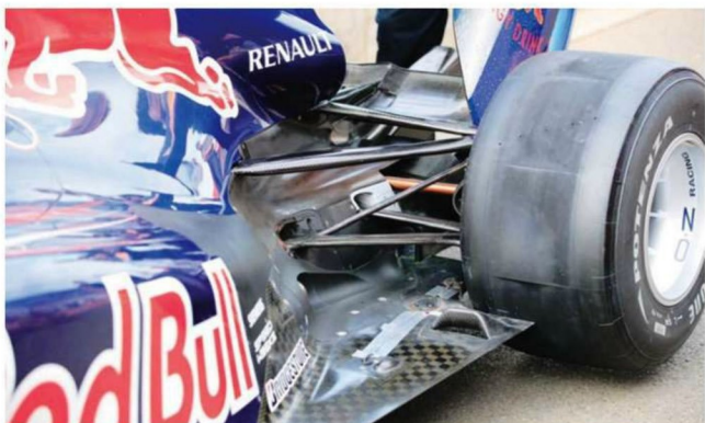
Rd.10 Great Britain 以前より深く挟まれたエンジン排気が流れる後方ポディワークに、隔壁構造の開口が設けられていることがわかる。ディフューザーのアップパーデッキにつながっており、内部の流速が高まる。
