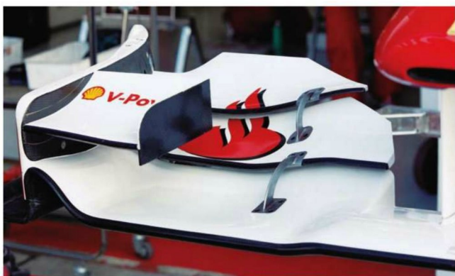
Rd.10 Great Britain シルバーストンからフロントウイングを新型化。開幕からの仕様は一貫してシングルフラップだったが、ダブル化がなされている。マラネロ得意の複雑な後方カットが施されている。
