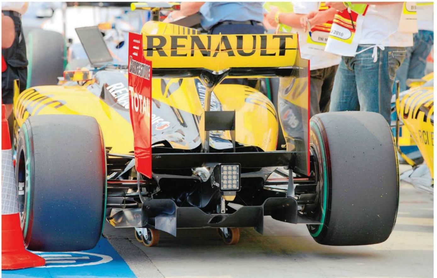
Rd.12 Hungary 新型化されたディフューザー。サイドチャネル上部の形状が角張ったものとなり、内部のスプリッター装備が消滅している。ロフウイング上のサブエレメントは、スタンダードに近い形で装着されている。
