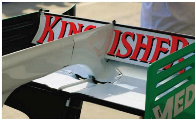
Rd.12 Hungary リヤウイングは主翼の中央にダクト開口があり、前方はその幅に合わせてわずかに位置が低く、気流の径路を形づけている。真ん中にはスプリッターが通り、Fダクトはその直後で接続。
