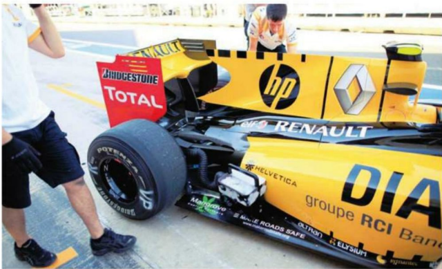
Rd.9 Europe 当初カナダにもFダクトを持ち込むのではないかとみられたルノーだが、夏のヨーロッパラウンドを迎えても、シャークフィンカウルは以前の仕様のまま。接続型としてもいない。
