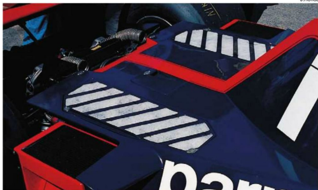
水平対向12気筒の吸気に関し、ブラバムは試行錯誤を繰り返した。結局インダクションポッドを設けない手法に、白い部分はエアフィルター。(Rd.4 USA West)
