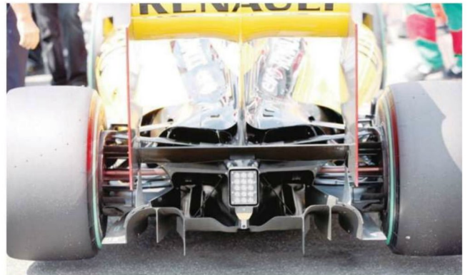
Rd.11 Germany このドイツまで使われたタイプのディフューザー。サイドチャンネル上部の縁が丸く、隔壁で気流の径路はふたつに分けられる。アッパーデッキから2本の吊り下げステーによって補強される。
