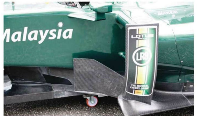
Rd.11 Germany バージボードはペイントがされておらず、カーボン地がむき出しの状況。前方はノーズ下のダミープレートにマウントされている。サイドポンツーン下の絞り込みは弱く、気流の径路が狭い。
