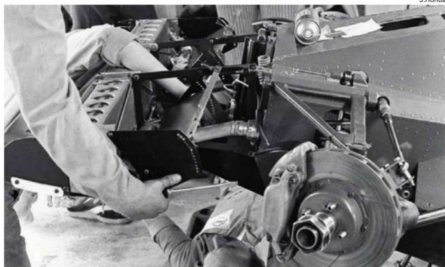
ラジエター後方には調整式フラップが装着され、エアの抜けやダウンフォースをコントロールする。フロント・ラジエター化にともない、トレッドはオリジナルBT46より約125mm拡大。(Rd.10 Great Britain)
