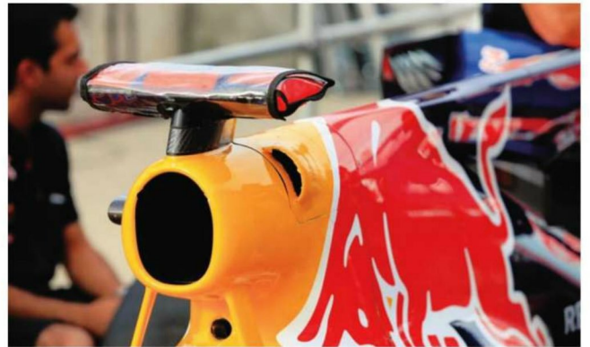
Rd.10 Great Britain レッドブルのFダクトは通常、エンジンインダクションボッド内の仕切り上部から空気を採り込む。シルバーストンにはサイドから吸気の別仕様も持ち込まれ、フェッテルのみが実戦でも使った。
