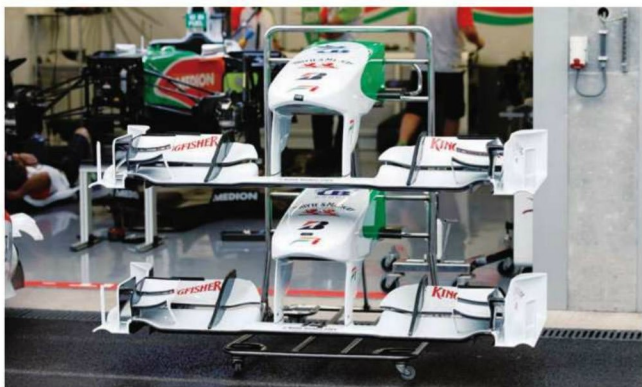
Rd.13 Belgium スパには、ダウンフォースレベルの異なる2種のフロントウイングのスペックを持ち込む。上のウイングはスプリッターの内と外でフラップに段差があるのに対し、下はほぼツライチだ。
