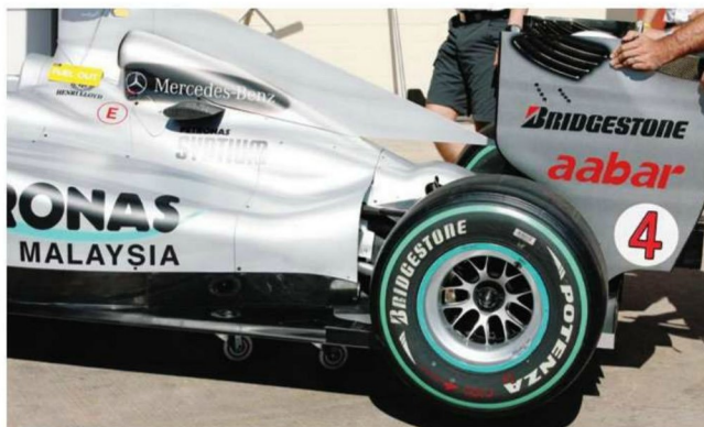
Rd.9 Europe 初期仕様のプロウンディフューザー処理。リヤタイヤの直前、カウルの織目目下の黒いカーボン地むき出しの箇所後ろにわずかに、円形のエンジンエキゾースト・テールパイプがのぞいている。
