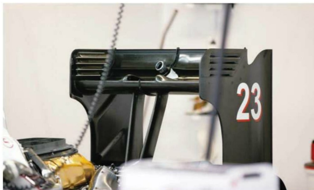
Rd.11 Germany リヤウイングの主要中央の開口直後に、Fダクトの接続はある。ドライバーが操作を行っていないときにはここに許容量の空気が流れ、裏面のスリット処理からウイングを剥がれずに放出される。
