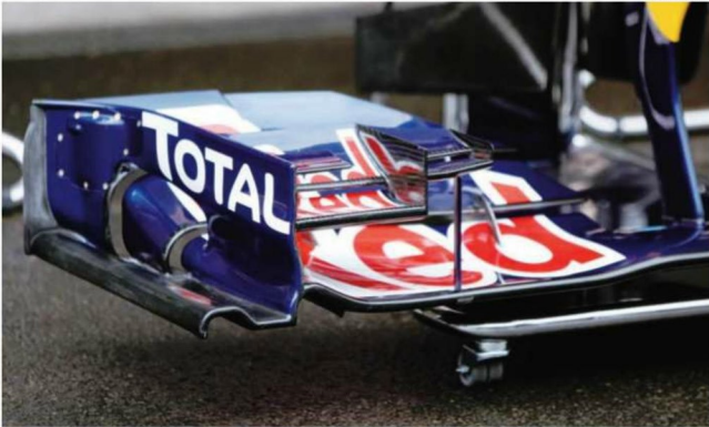
Rd.13 Belgium スパ向けのレスダウンフォース寄りフロントウイングは、通常仕様でみられるフラップ最後方のガーニー装着がない。さらに翼端板開口は前方に動き、低い位置で抑えられている。
