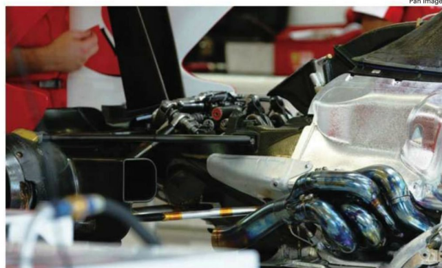
Rd.9 Europe ブロウンディフェューザー導入で、当然のことながら、エンジンエキゾーストのとり回しは一変した。前に曲げられていたものが後方へ、下に低く伸ばされている。捕器類のレイアウトも見直しがあつた。
