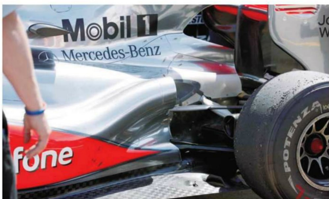
Rd.10 Great Britain マクラーレンはこのシルバーストンに初めてブロウンディフューザー処理を持ち込んだのだが、金曜フリー走行でのデータが思わしくなく、土曜日以降は従来仕様に戻されていた。
