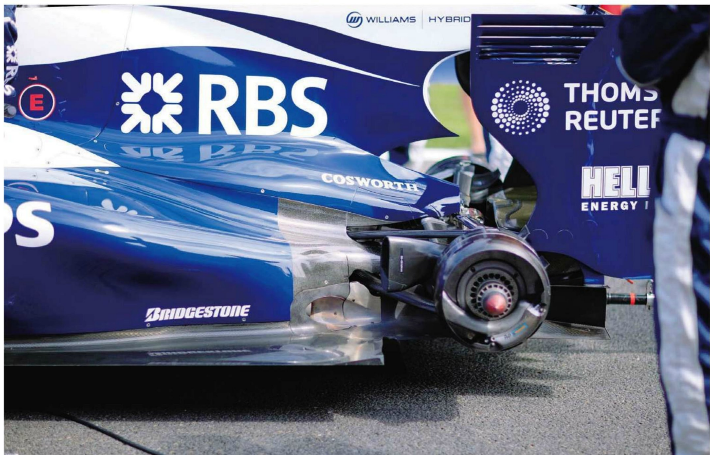
Rd.13 Belgium リヤタイヤが外されているために、エンジンエキゾーストの後方処理がはっきりとわかる。プロウディフューザー導入時とはすでに形状が異なっており、より深く、より長く、排気の径路が確保される。
