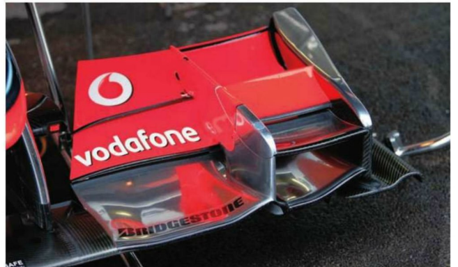
Rd.13 Belgium スパで投入された最新スペックのフロントウイング。レスダウンフォース仕様とみられ、従来型ではノーズ近くまで伸ばされるアッパーエレメントが、スプリッター外まで短くカットされている。
