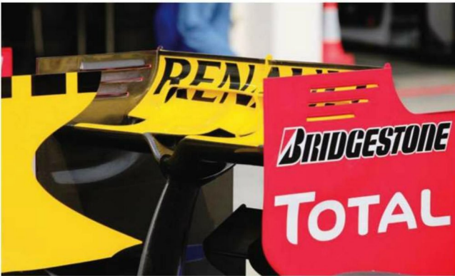
Rd.12 Hungary モナコと並ぶハイダウンフォースコースで持ち込んだ、新型リヤウイング。翼はストレートタイプとなり、ダクト開口が3カ所ある。中央の開口の下はV字に折られ、空気の流入を促す。
