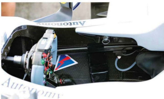
Rd.10 Great Britain メルセデスの“パッシブ”Fダクトは、吸気をフロントサスのアーム近くに左右の小さな開口を設けることによって行なっている。ドライバーによる操作はなく、コックピット内をダクトが通過。
