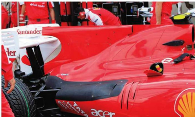
Rd.8 Canada ブロウンディフェューザー導入以前の仕様。エンジンのエキゾーストをサイドポンツーンのかなり前方の位置で出している。F10の特色とも言える処理だったが、レッドブルにおよばず、大きく舵を切る。
