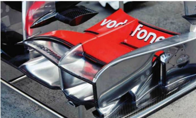
Rd.10 Great Britain 新型フロントウイングには、従来タイプにはなかった翼上のスプリッターを設定。大型でフラップからアッパーエレメント、主翼までを接続する。エレメント真下の主翼には、上への折り返し。
