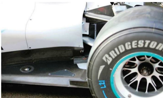
Rd.10 Great Britain わずか1戦で開発の手が入られた、プロウンディフューザー処理。テールパイプと接するカーボン地むき出しのカウル外側を三角にカット、熱気の出口が外向きに修正されている。
