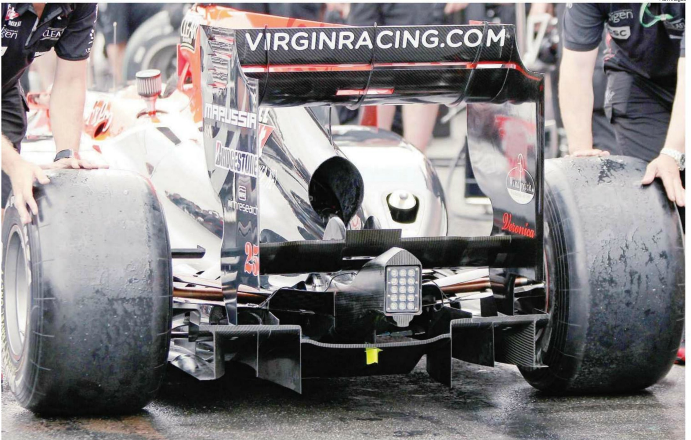
Rd.11 Germany バルセロナ時点で入れた改良から、カウル後部を大きく円形に空けるレッドブル風処理を採用。アッパーデッキの開口が拡大されたディフューザーやロウウイングの効果を、エアを流すことで高めている。
