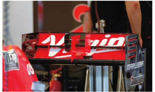
Rd.12 Hungary ハイダウンフォースコースのハンガリーでは、リヤウイング上にサブエレメントを設置してきた。左右エンドプレート間に強めの仰角を持つフラップが、2枚配されている。
