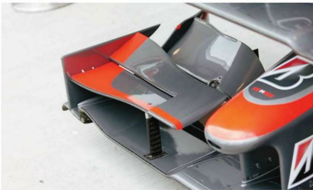
Rd.12 Hungary ワンスベックしかないフロントウイングで、あらゆるタイプのコースをしのがなければならない。支持の翼端板に複数のネジ穴があることで、アップパーエレメントは角度調整可能型だとわかる。
