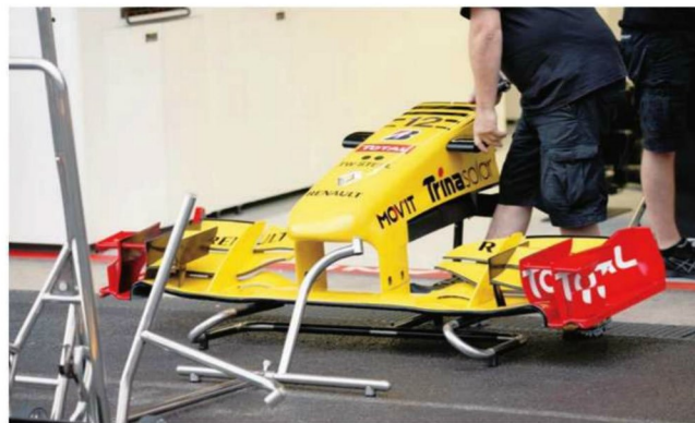
Rd.13 Belgium スバではフロントウイングをレスダウンフォース寄りに振らず、前戦で入れた新スペックをそのまま持ち込んできた。アッパーエレメントのもっとも外側には、エンドプレート処理がされている。
