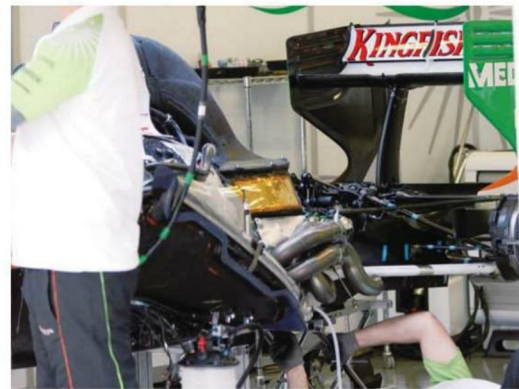
Rd.12 Hungary ブロンディフェューザー導入で、エンジンのエキパイ取り回しが変わり、テールが低い位置に来ている。カウル内のスペースには比較的余裕があったようで、さほど窮屈な折り曲げはされていない。
