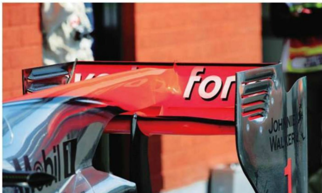
Rd.13 Belgium スパに持ち込まれたレスダウフォース寄りのリヤウイング。ストレートスピード重視のため翼弦長が短く抑えられ、仰角も弱い。Fダクト下メインプレーンの開口処理も行われていない。
