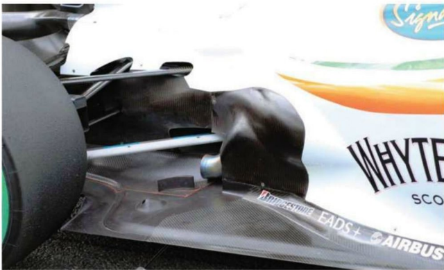
Rd.13 Belgium 前載ハンガーから、フォースインディアもブロンディフェューザー技術を導入した。だが、エンジンのエキゾースト後方に明確な気流を誘導する処理がなく、実験段階にとどまるレベルと言える。
