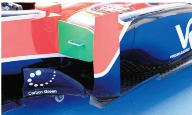
Rd.12 Hungary サイドポーン前部の空力処理は、側面に水平フィンが設置されたバードボードとサイドフェンスの間に他車と較べると、少し距離が空く。フロア前方は上に折り返されている。
