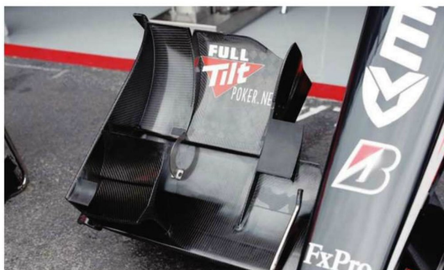
Rd.11 Germany シルバーストン以降のフロントウイングは、進化バージョンではなく、イチからの新設計と言って良さそうだ。メインプレーンもフラップも、以前のタイプとはすべて形状が異なっている。
