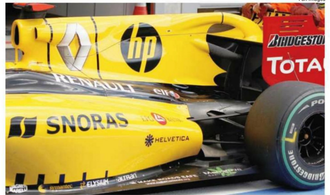
Rd.13 Belgium シーズン13観目で、ついに持ち込まれたFダクト。下側ダクトをリアの中央で出すため、ウイングのセンターステーはこれまでの1本から、間にスペースを持たせた2本構成に変更を受ける。
