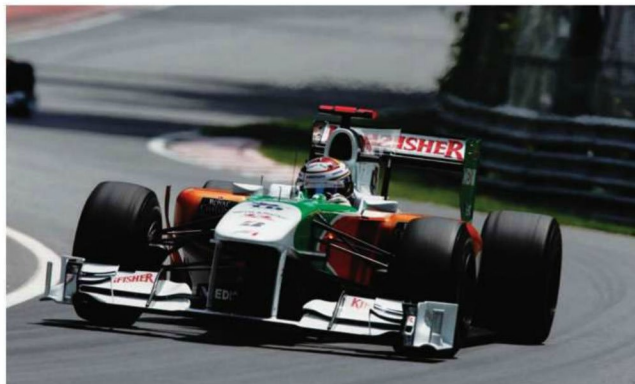
Rd.8 Canada セッション初日段階ではFダクト装備の走行も試していたが、前戦トルコから持ち込んだばかりでまだ完成度が低かったのか。レースには外して臨む。これ以降は、Fダクト装備が標準仕様となった。
