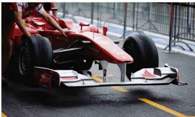
Rd.13 Belgium 高速SPAではレスダウンフォース寄りのスペックで、フロントウイングは以前のシングルフラップタイプに戻されていた。フラップ上の小さなスプリッターも引き続き装備されている。
