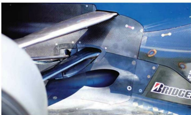
Rd.8 Canada ライバルチームたちが競って開発着手を表明、レッドブルがRB6で用いたエキゾースト処理は、急速にプロウndefューザーの命名で定着。エンジン排気でディフューザー効果を高めることのでいた名称だ。
