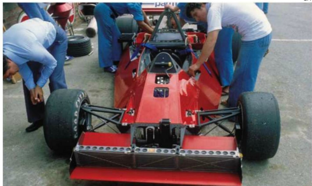
これまでは左右独立したラジエターだったが、BT46では左右一体として長さを稼ぎ、そのぶん高さを抑えるレイアウトとした。開幕の南米ラウンドでBT45Cに搭載して検討したものだ。(Rd.3 South Africa)
