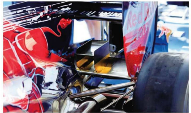
Rd.12 Hungary 昨年型では定評のあったダウンフォース量も不足。ハンガリーではリアのロウウイング上にサブエレメントを追加してきた。エンジン排気の影響があるようで、下半分に耐熱シールが貼られる。
