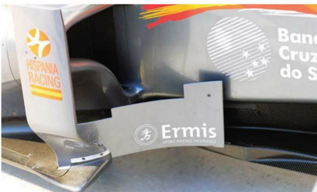
Rd.12 Hungary スクエアで上部に段差を持ったバジボード。ひと昔前の処理だ。サイドポンツーンの側方フェンスには工夫する余地もなく、セオリーのボードフィンとの接続前に内折られる加工がされている。
