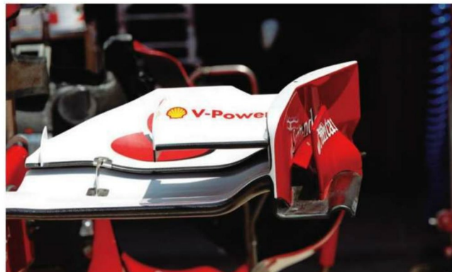
Rd.9 Europe このバレンシアまで使われたフロントウイングのスペック。シングルフラップで、前戦モンテリオールから内側に小さなスプリッタープレートが追加された。アッパーエレメントは翼端板を装備。
