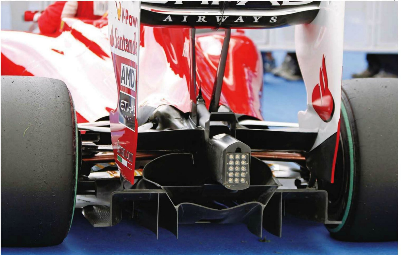
Rd.13 Belgium スパではリヤのディフューザーそのものにも、デザイン変更が行なわれていた。アッパーデッキ開口の奥に、ルノーに似た隔壁の処理がのぞく。だがこれも含めて新パッケージが機能せず、苦戦の道を歩む。
