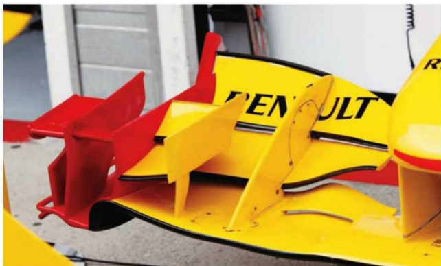
Rd.12 Hungary 前回の新型化から、2戦でまたフロントウイングの仕様を変更。メインプレーンはふたつに分離させたような形状から再度開口処理に戻され、前方翼端板は内と外が新たに連結されている。
