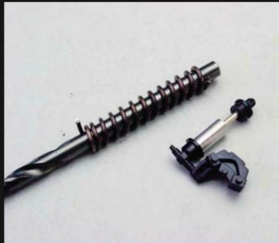
ショックアブソーバーのパーツは彫りも深く、そのままでも充分な仕上がりがかったが、今回はスプリングが伸び切った状態を再現したかったため、直径0.7mmの真鍮線を焼きなまし、ドリルの軸に巻きつけたものから自作した。
