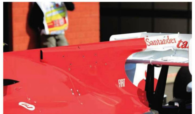
Rd.13 Belgium スバスペックのリヤウイングは、予選からレースにかけてはマッサのみが使った。こちらはアロンソが用いた仕様。通常スペックに近いダウンフォース量で、雨に懸けていたフシがみられる。
