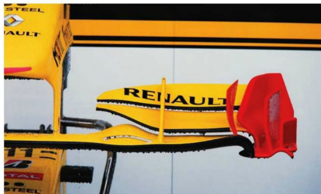
Rd.8 Canada レスダウンフォースペックとして、フロントウイングはアッパーエレメントを持たないタイプを新たに入れてきた。3層の翼端板構成は通常と変わらないが、内側の開口処理は小さくされている。
