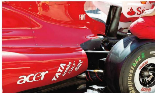
Rd.9 Europe 夏のヨーロッパラウンド開幕にブロウンディフェューザーを間に合わせる。跳ね馬の場合、内部も含めてサイドポンツーン全体を大きく造り換えなければならず、技術的には大きなチャレンジだった。
