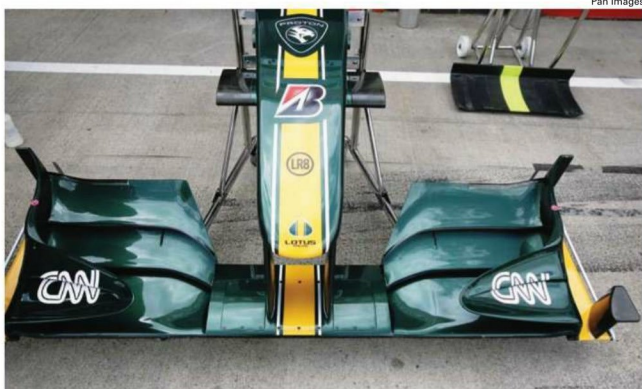
Rd.10 Great Britain ガスコインが今季最後のバージョンアップと称した、シルバーストン。新型化を受けたフロントウイングはアッパーエレメントの後部に折り返し、翼端板の外への曲げも強い。
