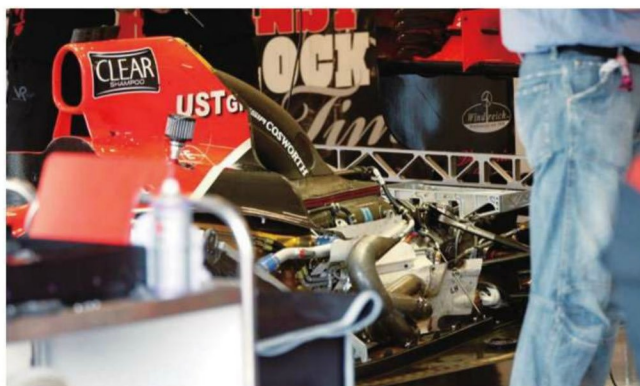
Rd.12 Hungary Fダクトにはまだ手を出していないため、エンジンのインダクションボックスはサイズがしっかり確保される。遮熱壁の形状や配置を見ると、カウル内の気流制御にも手つかずの段階だ。
