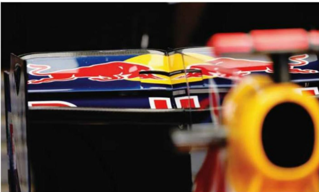
Rd.8 Canada 前戦トルコの金曜フリー走行でFダクトを試したが、このモントリオールのコースには一切持ち込まず。レスダウンフォース仕様にくるまを大きく振り、リヤウイングも究極の軽いタイプだった。
