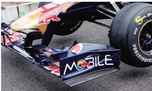
Rd.11 Germany フロントウイングの翼端板を変更。下の膨らみが強くなり、後端の折り返し形状にも手が入れている。ただし、次戦で見られたような外側下プレートの開口処理はまだない。
