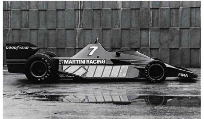
マシンサイドを覆う幾何学的な模様が、表面冷却システムが外気にさらされる部分。通常のラジエターではフィンに相当する。(1977 original BT46)
