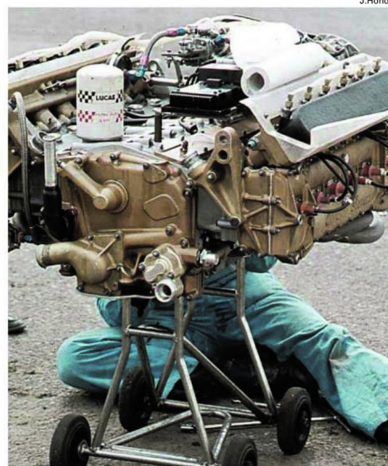
アルファロメオ水平対向12気筒ユニット。同じレイアウトを採るフェラーリよりもパワフルとされたが、重く大きい欠点があった。
