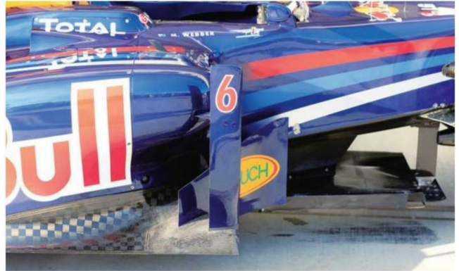
Rd.12 Hungary カナダで初登場し、レスダウンフォースベックかとみられた前後長の狭められたボンツーンのサイドフェンスだが、その後も基本デザインは踏襲。ハイダウンフォースコースでも使われている。
