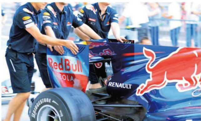
Rd.12 Hungary ストレートスピードがそれほど重要視されないハンガリーでは、マクラーレンを除く他の陣営と同様、Fダクトは取り外された。究極のダウンフォース量に関しては、こちらがやはり優るようだ。
