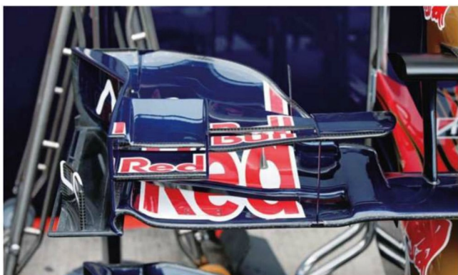
Rd.13 Belgium スパに持ち込まれたフロントウイングは、また仕様異なる。新型というより、レスダウンフォース向けのスペックか。翼端板下プレート真ん中の開口が消滅、小さな外向きフェンスが立つ。
