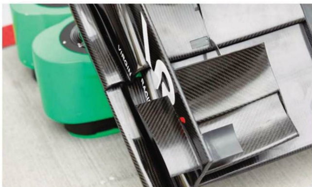
Rd.12 Hungary 翼端板処理も、バレンシアまでの仕様とはまるで異なるものだ。分割型ではなく単一エレメントとなり、外を前後に振り分けるような造作となる。外の水平フィンはこのハンガリーでの追加。
