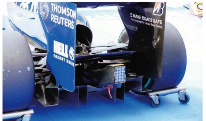
Rd.12 Hungary ディフューザーにマイナーチェンジ。サイドの処理に、前戦ドイツまではみられなかった下プレートの上への強い折り返しがある。エンジンカウルの後端には、レッドブルばりの巨大開口。
