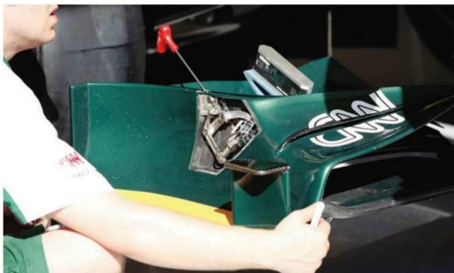
Rd.9 Europe 翼端板のカバーが外されて、フロントウイングの可変機構がのぞいている。小型のダンパーのようなものが見え、油圧を用いたシステムだ。今季限りの技術で、来年からリヤの可変が予定される。
