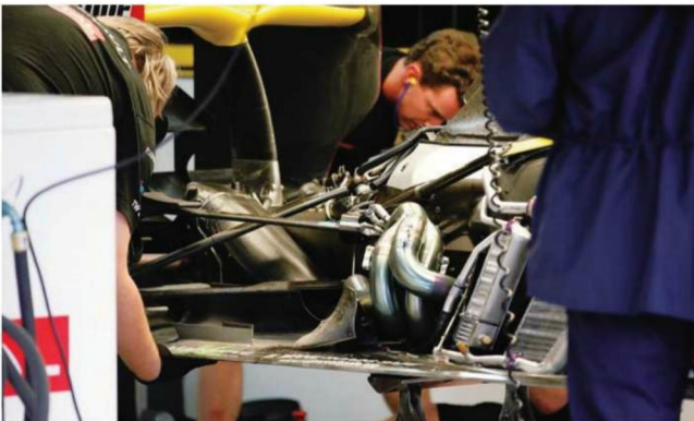
Rd.11 Germany 窮屈そうに縦長に折られたエンジンのエキゾーストパイプは、最後の段階で低く下ろされている。排気の出口には外に遮熱カバーのようなものがされるが、気流を囲い込む意味もある。
