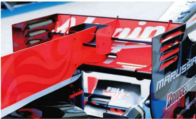
Rd.12 Hungary シャークフィンカウルが翼上サブエレメントを挟み込むようにして、リヤウイングのフラップに接続されている。メインプレーンの中央には、ダウンフォース増強セオリーのダクト開口がある。
