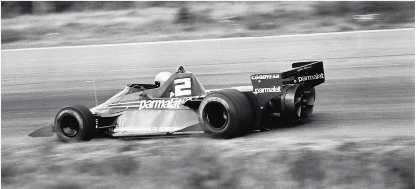
ファンだけでなく、エンジン上方にラジエターをマウントするために、エンジン・カウル周辺も大きなモディファイを受けた。ワトソンは予選2位につけファンの威力をアピール。(Rd.8 Sweden)
