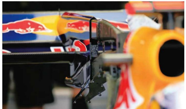
Rd.9 Europe マクラーレン他多くの陣営が使用するFダクトは、ドライバーの操作がない限りリヤのロウウイング近くでエアが抜かれる。だがレッドブルは、メインプレーンのすぐ下に出口を設定。
