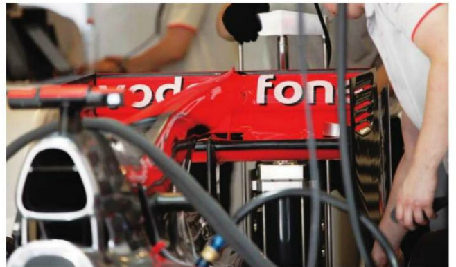
Rd.12 Hungary ハイダウンフォースペックのリアウイングは、Fダクト下のメインプレーンに大きな開口処理がある。中央には気流を左右に振り分けるような形で、スプリッター装備が通される。
