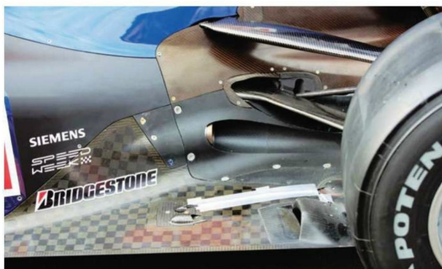
Rd.10 Great Britain 先駆者は慢心することなく、プロウndefューザーのさらなる効率化に動く。前戦バレンシアまでとは排気を後方ディフューザーに導く形状を改め、より貼りついて流れるようにした。
