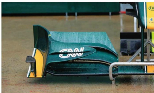
Rd.8 Canada モントリオールに持ち込まれた、もう一方のスペック。翼端板外に立つフェンスの上が、外へ三角に曲げられている。最後方のフラップは、早い時点で上への折り返しがつく。
