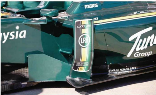
Rd.9 Europe サイドポンツーン前部周辺の空力デバイスは、オーソドックスに外側フェンスとバージボードの組み合わせ。外側フェンスは下に3Dデザインが使われており、内側に挟むような湾曲がある。
