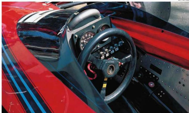
オリジナルBT46では、電子式インジケーターを装備した計器システムを搭載していた。実戦にも投入されたが、他にも数タイプのメーターパネルとレイアウトが存在する。(Rd.4 USA West)
