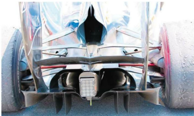
Rd.8 Canada 第9戦バレンシアまで使われたリヤディフューザー。アップパーデッキの開口は大きなサイズが確保されているものの、曲面処理は多用されておらず、シンプルとも言えるデザインだった。
