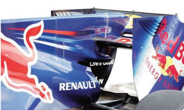
Rd.11 Germany トルコでのテスト段階からは、Fダクトにはいくつかの修正が行なわれている。リヤウイングとの接続上部は以前のフラップとのツイッチから上端がカットされ、アールを描く形状となった。
