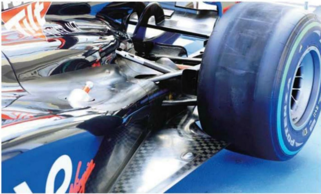
Rd.12 Hungary 同じ新規参戦組でライバル視するロータスと較べると、クルマのリアエンドの絞り込みのレベルは上だ。リヤウイングセンターの補助的支持には、独特のフック型ステーを使っている。
