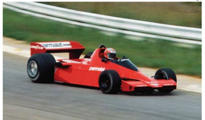
結局表面冷却はまったくの容量不足で廃止され、従来のフロント・ラジエター式に変更された。デビューレースは第3戦南アフリカ。以降とはカラーリングが異なる。(Rd.3 South Africa)
