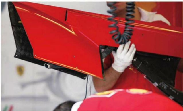
Rd.8 Canada カウル左から先端が突き出た配管が、そのままFダクトの上部につながっていることがわかる。ここからのエアがダクト内で気流の向きを変え、高速区間でリヤウイングをストールさせる働きをする。
