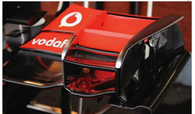
Rd.13 Belgium スパ・スペックのフロントウイングはアッパーエレメント以外、目立った仕様の変更なし。翼端板は前後分割型にも見えるが、上部は単一エレメント。主翼の折り曲げは、複雑な3Dの造作だ。
