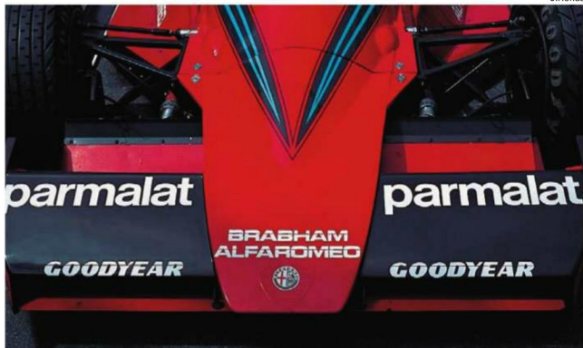
不本意な形でフロント・ラジエターへの変更だったが、そこはマーレイ、転んでもただでは起きない。従来デザインを一新し、ウイングノーズなみの薄いデザインを実現した。(Rd.4 USA West)
