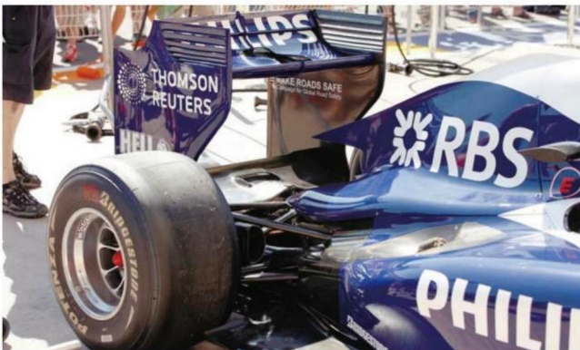
Rd.9 Europe ノーマルカウル最後の仕様。このバレンシアでは、フルケンベルクのみが走らせた。リアウイングはメインプレーン中央に大きなダクト開口。ロウウイングにも、同様の処理が施されている。
