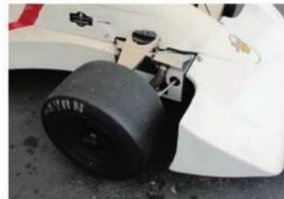
当時はラバースプリングが特徴的なサスペンションだったが、メンテナンスの都合か、現在は通常タイプに戻されていた。
