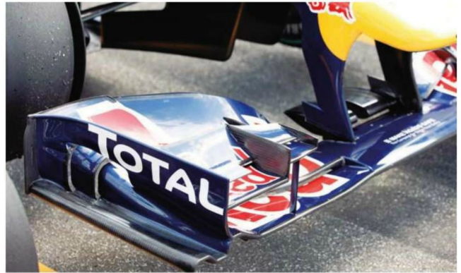
Rd.11 Germany 従来型のフロントウイングでノーズ脇にあったダミーカメラは、ステア内側の翼近くに移動。メインプレーンはスリット周辺の処理が異なり、翼端板は開口が高く高い位置に移されている。
