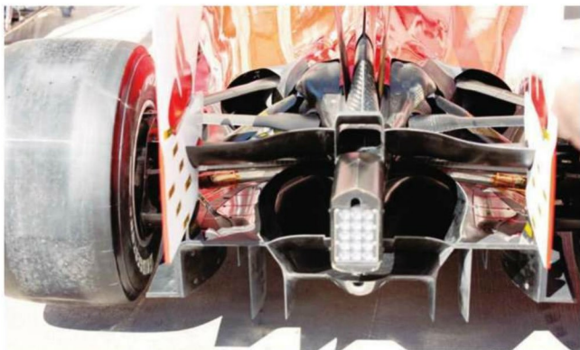
Rd.9 Europe パレンシアでのディフェューザー変更は、マイナーチェンジの域にとどまるレベル。センターチャネルの上部隔壁が以前とは逆に、下の膨らみを持つ。エンジン排気の径路には、温度管理シールが多数。
