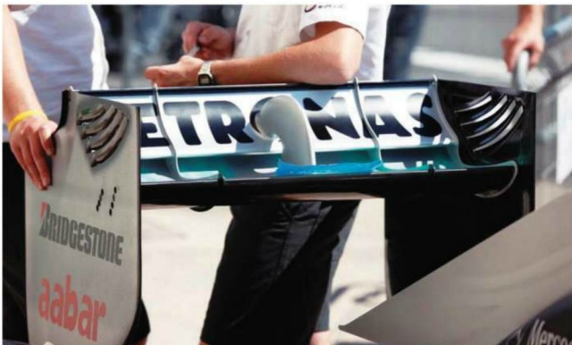
Rd.9 Europe 従来スペックのリヤウイング。中央のシートが被せられた2カ所の開口と前方ダクトからのエアを合わせ、中空のフラップ内に充填。許容量を超えると後方に吹き出し、ウイングをストールさせていた。
