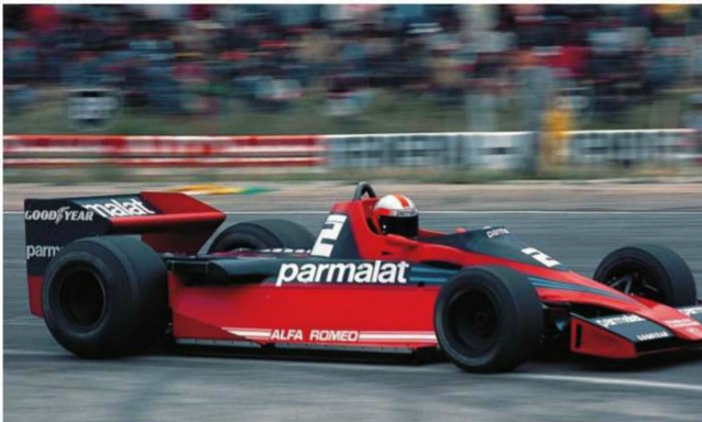
中盤以降、レースによってはコックピット後方のエンジン・カウルに、ファンカーに準じたような、サイズの小さい“絶壁”型カウルを装着していた。(Rd.9 France)
