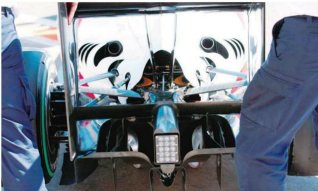
Rd.9 Europe ヨーロッパラウンド初期の仕様より、ディフューザーのアップパーデッキの開口が横へ拡大されている。下のサイドチャネルの隔壁処理も数が減らされ、気流の径路を広く確保する形となった。
