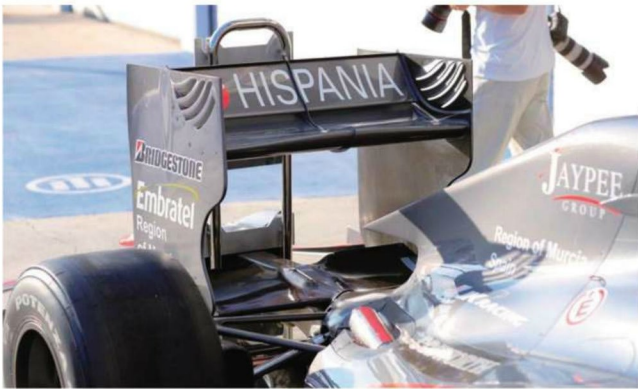
Rd.12 Hungary リヤウイングは補助のセンターステーを持たない。それほど攻め込んだ設計をしていないので、強度面にはまったく問題なしということか。ダクト開口等、ダウンフォース増強処理も皆無だ。
