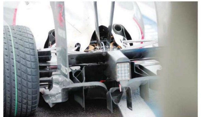
Rd.13 Belgium 冷たい雨の降るスパで、カウルのエキパイ直前の開口は完全に閉じられていた。ディフューザーそのものの基本設計は以前のままで、サイド外側に複雑な曲面加工の手が入られた。
