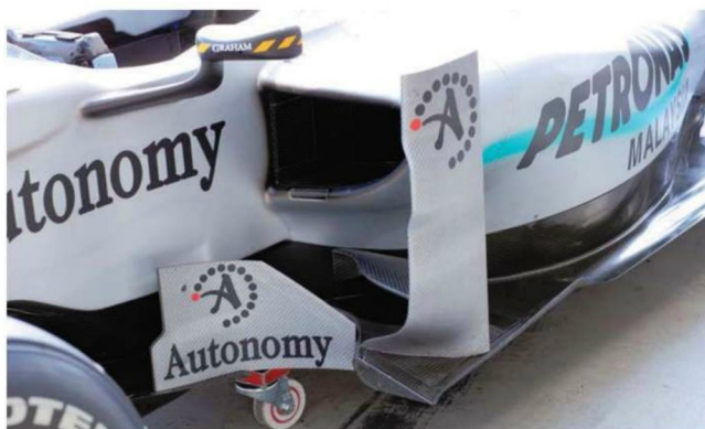
Rd.12 Hungary サイドボーン前方の気流制御処理は、バジボード+外側フェンスの構成。フェンス内側の車体支持が凝った造りを見せるが、大きな仕様の変更はない。ポッド前の小型フィンも廃止。
