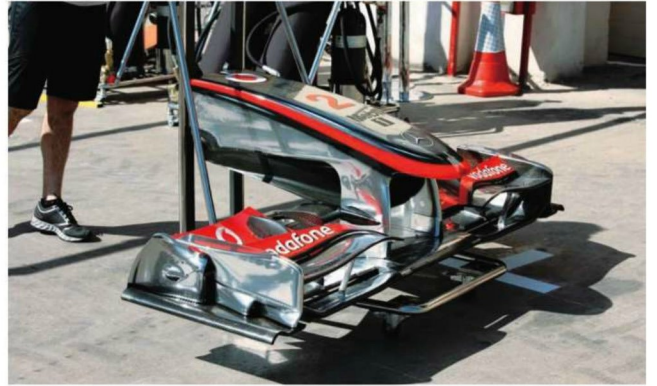
Rd.9 Europe 前後に分割されたマルチエレメントタイプの翼端板を持つフロントウイングは、欧州ラウンド開幕のバルセロナで導入。2戦後のトルコで形状にマイナーチェンジの手が入れられた。
