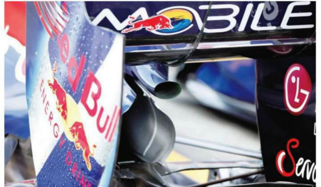
Rd.11 Germany 通常時におけるFダクトのエアの出口。横長の楕円のような形状をしている。しかしチームはこの出口付近を本体とは別体パーツとしており、前戦シルバーストンでのスペックとは異なる。
