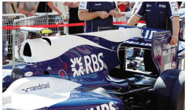
Rd.9 Europe 第4戦中国の金曜フリー走行で試されたあと、一度は封印。シャークフィン接続型のFダクトが、ついに顔の目を見る。下側にエアの排出を持たないのが特色。投入縦軸はバリチェロのみが使った。
