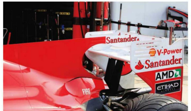
Rd.12 Hungary ハイダウンフォースペックのリヤウイングは、メインプレーンの中央に小さくダクト開口を持つ。ハンガリーでの仕様でFダクトは装備せず、カウル下には細長い切り欠きを設定。
