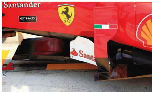
Rd.12 Hungary フロントウイングと同様に争点となっている。フレキシブルフロア疑惑。前方に伸びるダミープレートが高速になると風圧で持ち上がり、車高が下がりがながらも路面との接触を避けると言われる。
