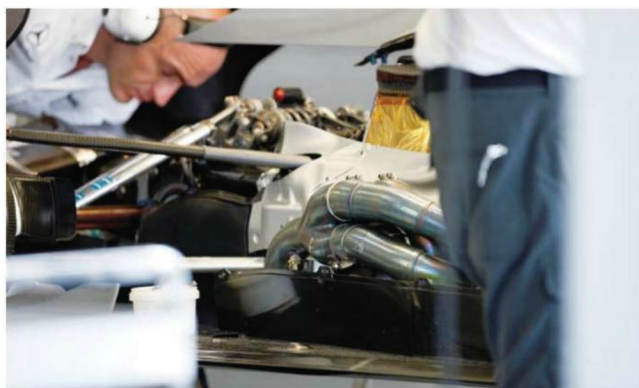
Rd.9 Europe プロウンディフューザーの導入に伴って、当然のことがエンジンのエキパイと回りも一新。以前は高い位置にあったテールパイプが、フロア方向へ向かう。近辺の耐熱処理にチームは悩まされた。
