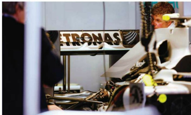
Rd.11 Germany 新型リヤウイングはメルセデス本体のお膝下、ドイツで登場した。主翼中央にダクト開口を設けたハイダウンフォース型だ。後方フラップの小さな2カ所の開口は、Fダクト装備の可能性を残す。
