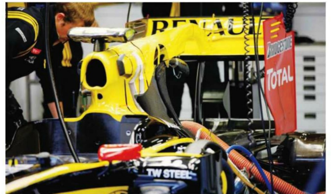
Rd.13 Belgium 上部ダクトは自家マクラーレンのフラップとは異なり、リヤウイング主翼へ接続する“ザウバータイプ”だ。そのリヤウイングは新しい仕様で翼形が異なる他、翼端板に縦のスリットが入る。
