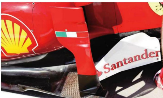
Rd.9 Europe 昨年レギュレーションから大幅な規制が加えられたことで、サイドディフレクターの開発は以前ほど活発ではなくなった。フェラーリもミラー撤去命令に応じての変更以来、ほぼモディファイの形跡なし。
