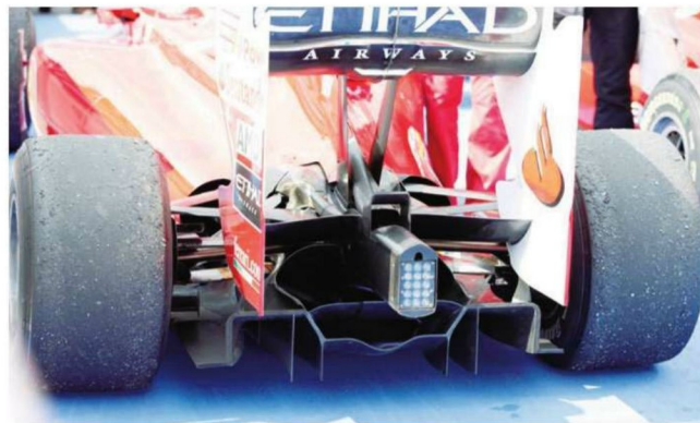
Rd.11 Germany ドイツからのディフェューザー仕様は、センターチャネルの上部隔壁が単に下に膨らむのではなく、完全な気流の径路とされた。排気の熱がおよぼす影響はデータが採れたのか、温度管理シールが消滅。
