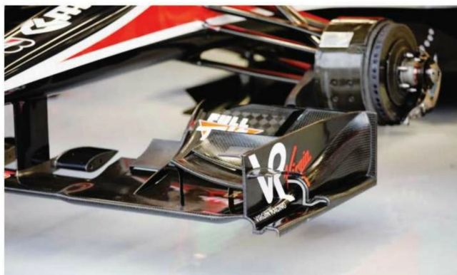
Rd.13 Belgium スパ・スベックのフロントウイングはベースのデザインに変化はないものの、前戦ハンガリーからは細部に手加えられていた。翼端板外側フィンには、下に大きく湾曲されている。
