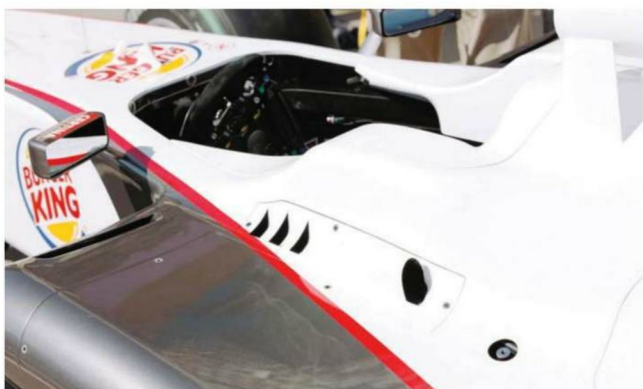
Rd.9 Europe サイドポツーンの前方にはエントリーダクトの直後に、今季マクラーレンに似た開口処理がされた。リヤビューミラーの周辺には、小型フィンの設置などの整流デバイス処理はされていない。
