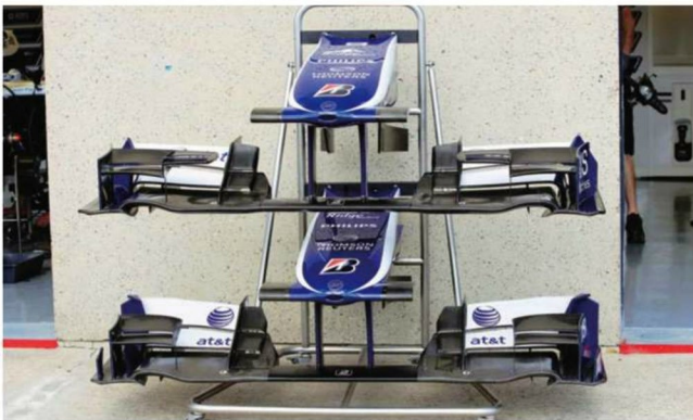
Rd.8 Canada モントリオールには、スペックの異なる2種のフロントウイングが持ち込まれた。上が新型だが、以前モナコで導入したタイプをベースとしたもの。旧型とはアッパー・エレメントの仕様が異なる。
