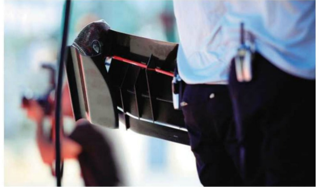
Rd.10 Great Britain シルバーストンには新旧2種のフロントウイングが持ち込まれており、こちらは旧スペック。翼端板下が内に深く折られ、翼下には3カ所のスプリッタープレート装備する。
