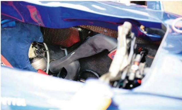
Rd.10 Great Britain コックピットの左サイドにあるFダクトの操作系。赤いキャップのようなものがされているが、ドライバーがこの開口を押さえて動作させる。さらに改良が加えられ、現状の仕様とは異なる。
