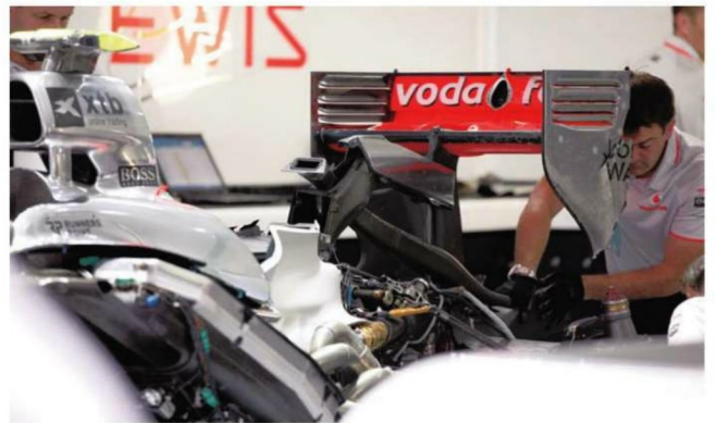
Rd.11 Germany Fダクト本体が取り外され、クルマのリアエンドに向かう後部構造だけが残されている。エアは流れる径路を狭められたり広げられたりしながら、最後はクラッシュパルストラクチャー上に導かれる。
