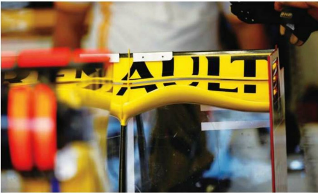
Rd.8 Canada 今季ルノーはリヤウイングにセンターステー左右で主翼が盛り上がる独自形状を用いてきたが、レスダウンフォース仕様ではさらに極端化。前方がめくり上がるようなシェイプとなっている。
