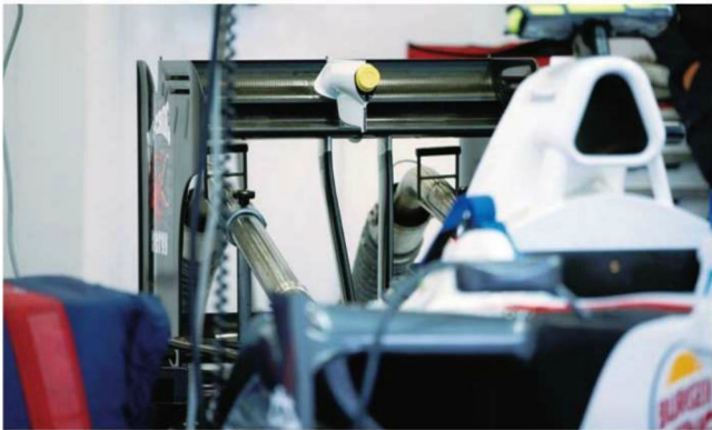
Rd.13 Belgium ストレートスピードとダウンフォースのバランス。スパでは、カナダ以来となるFダクトのリヤウイング・フラップ接続が復活した。すなわち、クルマが最高速寄りに振られたということだ。
