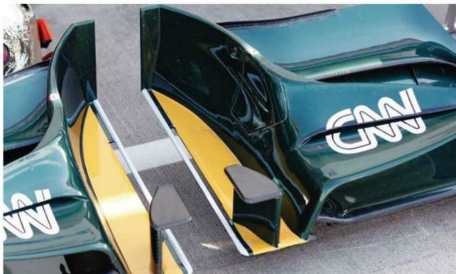
Rd.10 Great Britain 右が以前からあったスペックで、左が新型のフロントウイング。新型は翼端板の外への曲げ方がより3Dデザインを強めた形となっており、外に立つ垂直フェンスはサイズが小さい。
