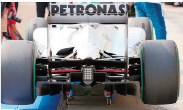
Rd.12 Hungary 昨年型ブラウンの最終形と、さて変化のないリヤディフューザー処理。アッパーデッキの開口サイズが他の上位勢のクルマと較べると、著しく小さい。完全に追い抜かれた形だ。
