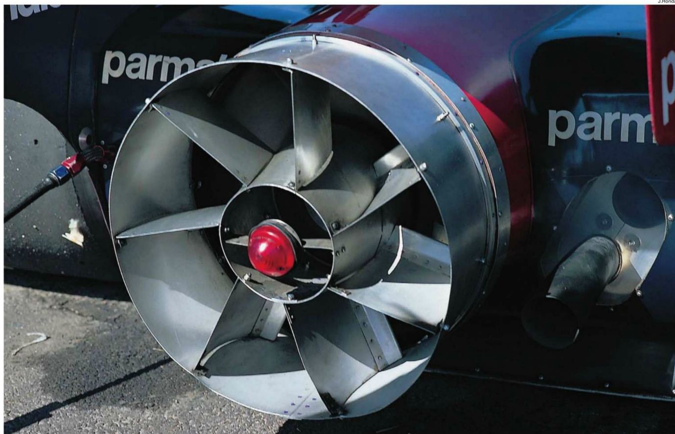
ファンは最初プラスチック、次にFRPで作られたが破損してしまい、最終的に金属で鋳造された。予選初日はスカートの一部が偏摩耗したが、翌日以降は所定のサクションを得られるようになった。(Rd.8 Sweden)
