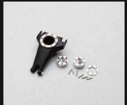
ホイールハブ関連の工作は、今回ももっとも手間が掛かった工程のひとつ。外周のリング部分と同様、アルミ材から旋盤で削り出した後、治具を使って直径0.5mmの穴を等間隔で開け、短く切った洋白線を1本ずつ接着している。
