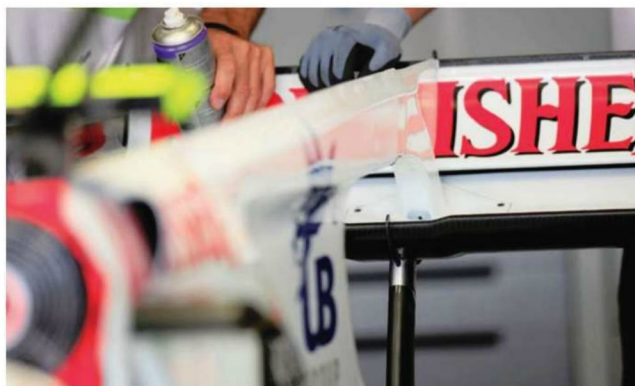
Rd.9 Europe フォースインディアのFダクトも、気流の径路はリヤウイングのフラップではなく主翼の方へ設定されている。フラップへの接続はシャークフィン本来の目的の、きれいな空気を流すためだ。
