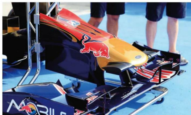
Rd.12 Hungary このハンガリーからのタイプは新型フロントウイングというより、新型ノーズコーンと書いたほうがいいのかもわからない。これまでにはなかった、ノーズ下フェンスも追加されている。
