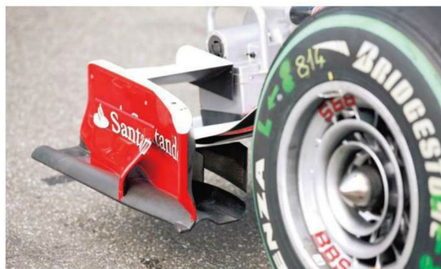
Rd.11 Germany 新型フロントウイングを後方から見る。翼端板下のプレートは内側が深く上に折られ、奥の翼下には2枚のスプリッタープレートがのぞく。レッドブル同様のフレキシブルウイング疑惑があった。
