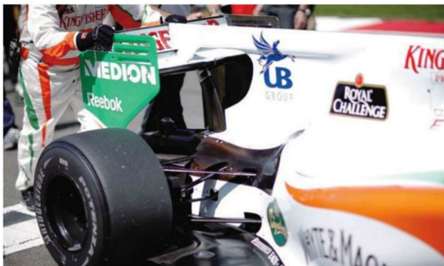
Rd.10 Great Britain ドライバーが操作を行わないときのFダクト気流径路は、本家からのセオリー通りにリヤのロウウイング上に向かって抜かれている。カウルは切り欠いてウイングと距離を置く形だ。
