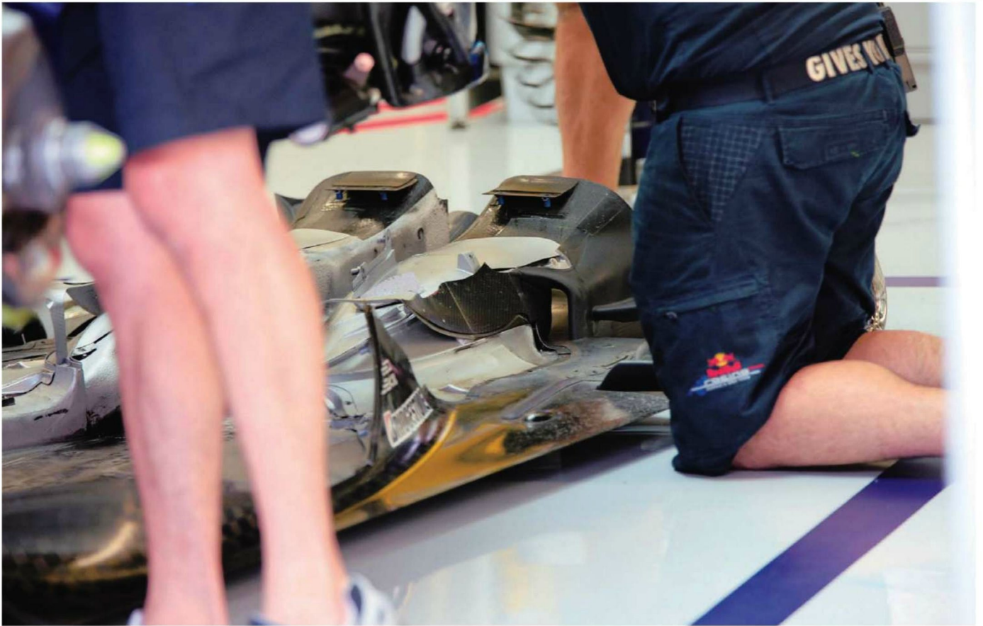
Rd.13 Belgium フロアパネルの後方で高く跳ね上げられた、マルチディフューザーのアップパーデッキ。エンジン排気が流れる開口の内側を、ボディ下からの気流が通っている。合流させることで、引き抜き効果が強まる。
