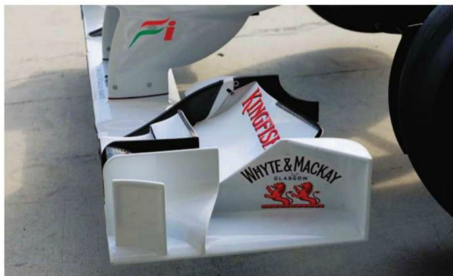
Rd.12 Hungary ハンガリー仕様のフロントウイングは、後端が翼端板から飛び出すほどにフラップ面積が稼がれていた。外側の角を囲い込むように、ガーニーがつく。ステーは上が後方に丸みを帯びる。
