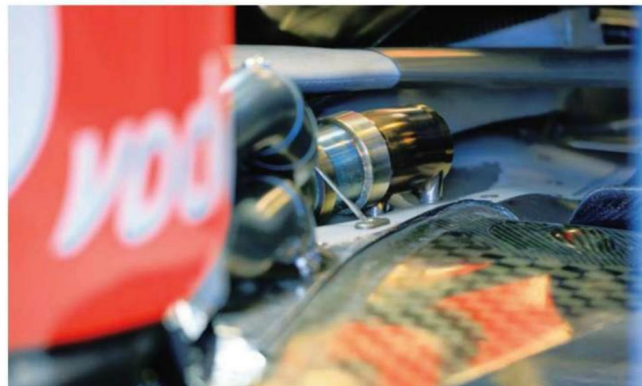
Rd.10 Great Britain ブロウンディフューザーという言葉ばかりがひとり歩きしているが、その起点となるのがエンジンのエキゾースト処理。フロアに熱気を貼りつかせるため、低い位置にテールパイプを置く。
