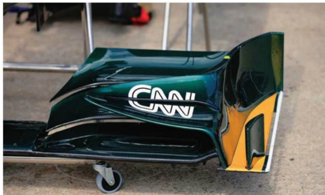
Rd.8 Canada 以前からあるスペックのフロントウイングだが、カナダにはレスダウンフォース仕様として持ち込まれてきた。翼端板外の下プレートから生えるフェンスは垂直で、外への弱い折り返しがつく。
