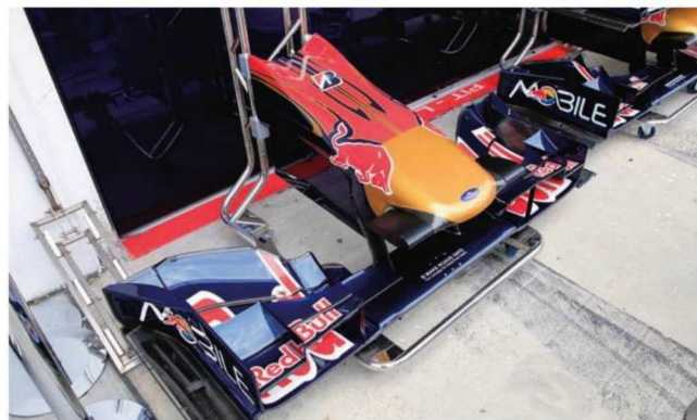
Rd.12 Hungary 前戦ドイツで一部先行パーツを入れていたフロントウイングを完全新型化。翼端板にはドイツでのスペックに下プレート中央の開口を追加、アッパーエレメントも一新されている。
