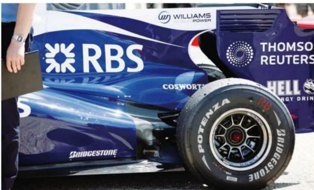
Rd.10 Great Britain 前戦のFダクトに続き、矢継ぎ早の新技術の導入。チームの自国開催では、新たにブロンディフューザー処理を入れる。エキゾストの開口は、リヤタイヤにかなり近い位置にある。
