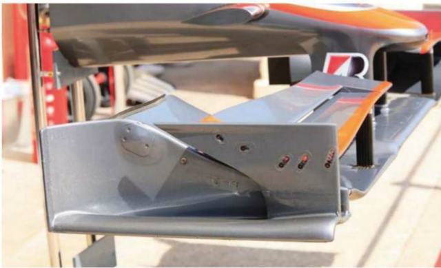
Rd.9 Europe フロントウイング翼端板は前後分割型。ただし線級のクルマたちのように凝った処理はされておらず、前後エレメントの間で若干の気流径路が確保され、わずかに振り分けがされる程度だ。
