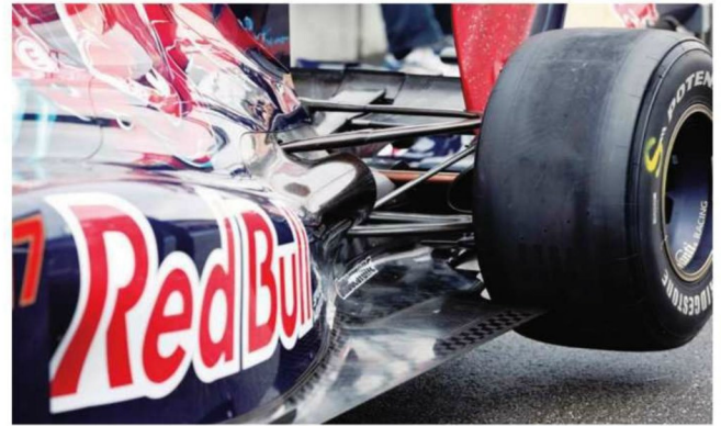
Rd.11 Germany エンジンのエキゾーストはリアのサスペンションアームの上下間を縫うように、後方へ抜かれる処理だ。流行のリアタイヤ直前のフロアに開口を設ける処理もなく、モデル落ちのイメージを拭えず。
