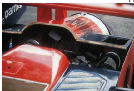
大きくモディファイされたリアエンドには、トランスミッションからの動力で駆動されるファンが装着されていた。目的は明白だった。
