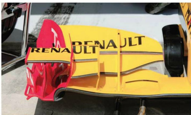
Rd.9 Europe 従来スペックに戻されていたフロントウイング。前方翼端板は深く内側に折られ、翼上でアッパーエレメントを仕切る役割を果たす。外は水平翼、内はフラップを持ったウイングレット構造に分かれる。
