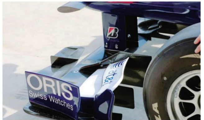
Rd.12 Hungary カナダ以降、フロントウイングに大きなデザインチェンジはされていない。シーズン序盤の仕様にあった翼端板外のプレートは消滅している。フラップ最後方には、かなり高いガーニーを装着。
