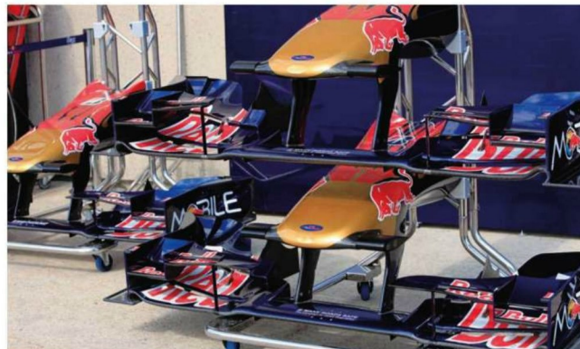
Rd.8 Canada 高速レイアウトながら路面コンディションによってグリップレベルがまったく変わるカナダには、2種類のフロントウイングで対応。下のウイングは、アッパーエレメントが内に長く伸びている。
