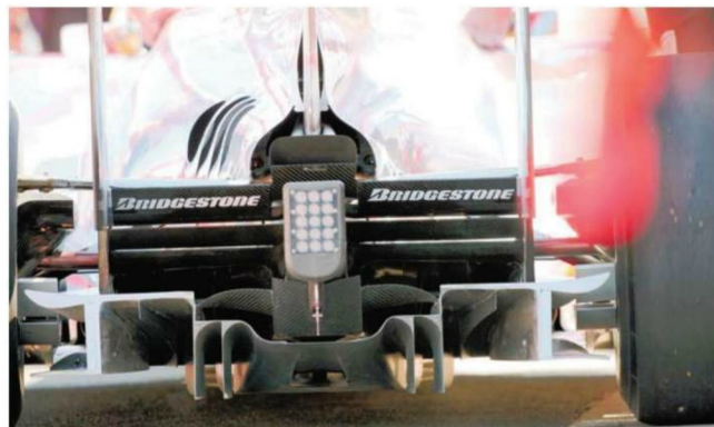
Rd.10 Great Britain ブロウンディフューザー導入によってエンジンのエキゾーストはフロア近くに動き、従来のテールパイプの位置にはカウル内冷却のための開口。左側のみ開穴が穿たれていた。
