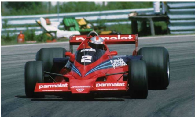
フロントにラジエターが不要になり、オリジナルBT46と同じウイング・ノーズが装着された。ノーズ前にはピトー管が置かれ対気速度を計測。コックピット右側には流速計が新設された。(Rd.8 Sweden)
