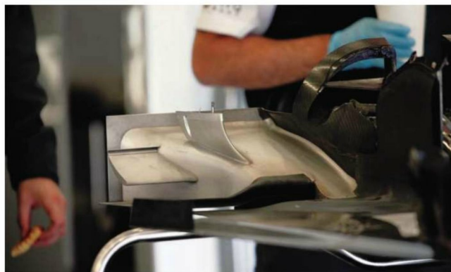
Rd.13 Belgium フロアとディフューザーの跳ね上げ間には、すき間処理が設定されている。周辺が焦げていることからわかる通り、エンジンからの熱気はここを径路とし、サイドチャンネル内に抜かれている。
