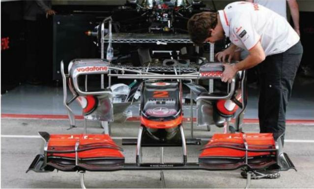
Rd.10 Great Britain シルバーストンでは、新設計のフロントウイングが投入される。メインプレーンの形状が以前は直線的でサイドのみがせり上がっていたものが、途中で1カ所上へ折り曲げられている。
