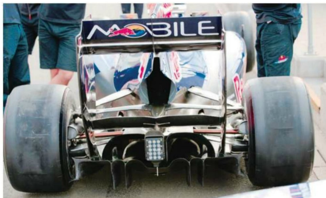
Rd.10 Great Britain リヤディフューザーは、シルバーストンから新型化された。ラウンドシェイプのアップパーデッキに大きなデザイン変更はなく、メインディフューザーの上部が何層にも折られるのが新仕様だ。
