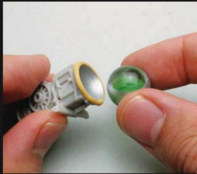
ギヤボックス単体で製作した場合の見栄えを考慮し、エンジン側(フライホイール)との接合面もある程度作り込んでおく。エポキシパテにビー玉を押しつけ、硬化を待ってから取り外して半球状の面を作る。
