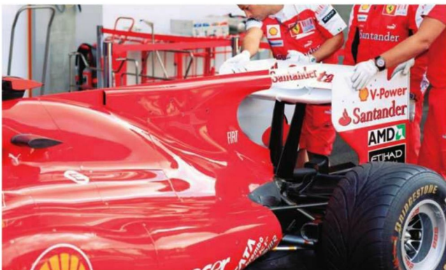
Rd.13 Belgium チームがスバ向けに用意した、レスダウンフォース寄りの開発型リヤウイング。メインプレーンの左右に上反角があるのが通常仕様とは異なり、フラップの仰角もかなり弱められている。
