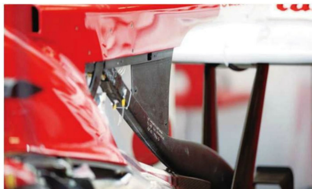
Rd.9 Europe フェラーリのFダクトは、吸気されたエアをリヤのロウイング上に導く径路が当初は狭く、後方で広くなるデザインとなっている。上部のダクトとは、仕切り板のような吊り下げで接続。
