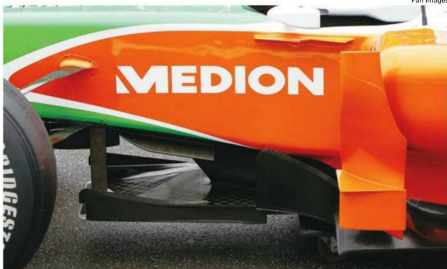
Rd.11 Germany ビブと呼ばれるダミープレートと脱着式の空カデバイスは、左右の上への折り返しが強くつけられている。ノーズ下には整流フィン。後方のバージボードとともに、カーボンの目が見える。
