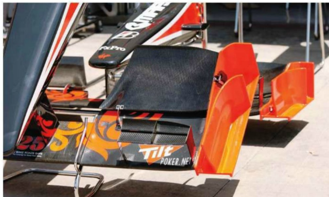
Rd.9 Europe このバレンシアのレースまで使われた、旧スベックのフロントウイング。翼端板は前後2枚の構成で、後ろのウイングにのぞくように間に小さな開口がある。アッパーエレメントは横長の処理だ。
