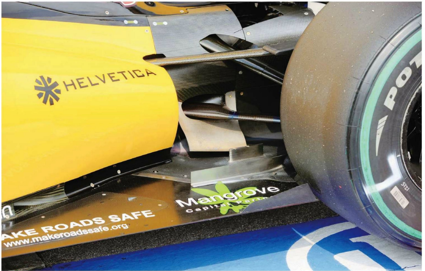
Rd.12 Hungary バレンシアでの初導入時よりプロウディフューザーの効率化のためか、エキゾーストの位置が後方に下げられ、サスペンションのレイアウトも変わっている。前ロワームを囲うように遮熱のカバー。
