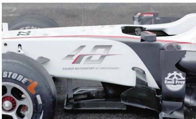
Rd.11 Germany ノーズ脇には、ザウバー・モータースポーツ創立40周年の記念ロゴ。その下のダミープレート処理は、中央に膨らみが持たせてある。バージボード、サイドフェンスともに3Dデザインを多用。
