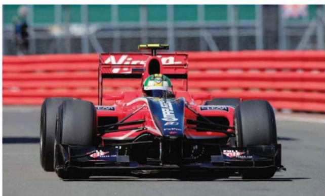
Rd.10 Great Britain シルバーストンではクルマに大幅なバージョンアップが行なわれ、フロントウイングも完全な新型だ。アッパーエレメントは昨季のブラウンが先鞭をつけた、ウイングレット処理となった。
