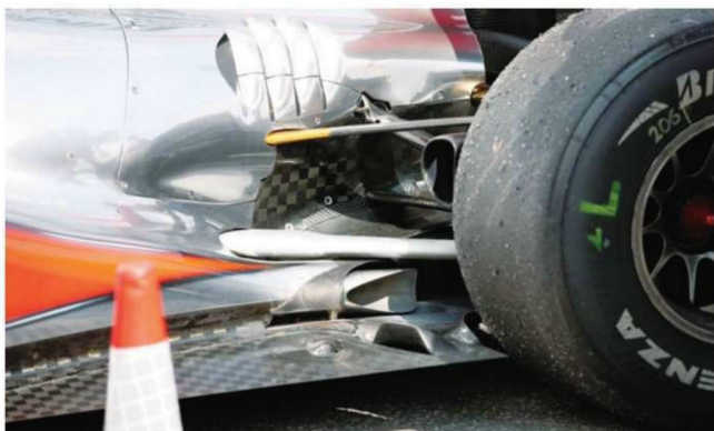
Rd.11 Germany 導入2戦目にして早くも改良の手が入られた、ドイツ本番向けブロウンディフューザー仕様。エキゾーストのテールパイプが円形ではなくなり、外向きに三角にカットされるような形状となった。
