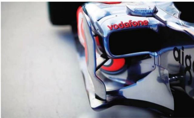
Rd.12 Hungary サイドポンツーン前部の空力デバイスは、横から見ると直線的デザインだが、実は複雑な3Dの折り返しを持つ。ラジエーターインテイクはサイズを狭めた結果、ほぼスクエアな形状だ。
