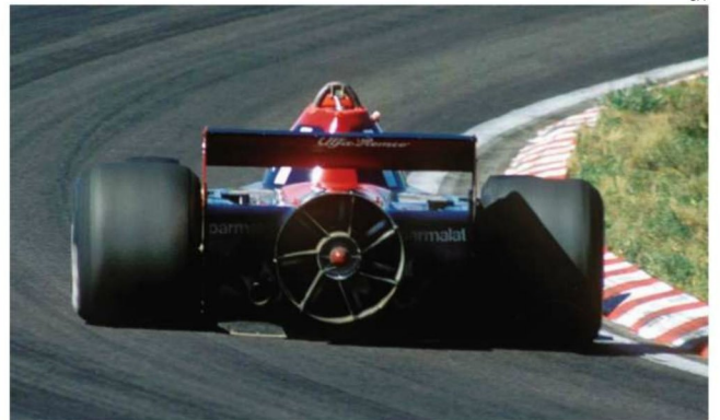
トップのマリオ・アンドレティを追うラウダ。外側の静止しているファンは整流用で、その奥のもうひとつのファンが回転して空気を吸い出す。スカートが路面に密着している。(Rd.8 Sweden)
