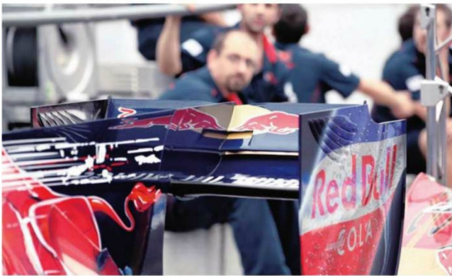
Rd.11 Germany Fダクトも導入とはいかず。昨年からの接続型シャークフィンカウルのまま、聞っている。リアウイングには、フラップ中央にダクト開口。だがこれも見慣れた仕様で、目新しい手法の採用はない。
