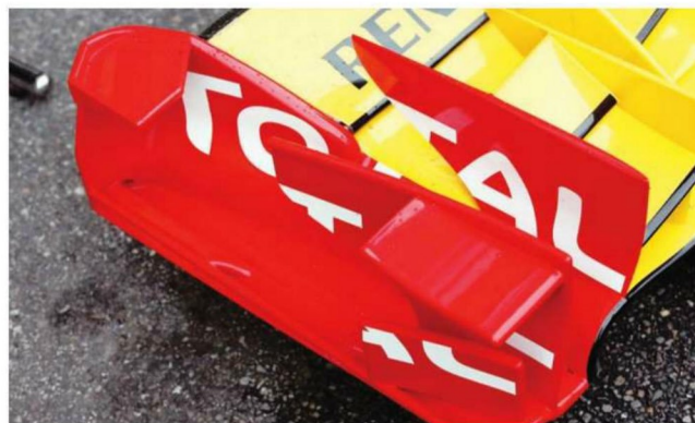
Rd.11 Germany 前戦からのフロントウイング仕様は、なくなった内側翼端板外の水平翼に代わるかのように外側で跳ね上げフィンを装備。後方翼端板上部の多角形デザインによる折り返しも、追加を受けた。
