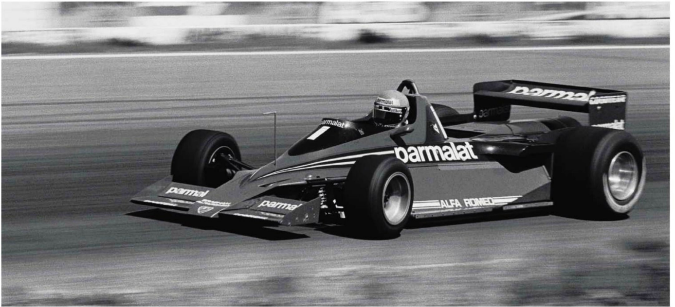
アンデルストープ・サーキットを、まさに路面に貼りついて走る。後部のファンと周辺のカウルの大きさは、このパーツが単なる冷却ファンではないことを物語っている。(Rd.8 Sweden)
