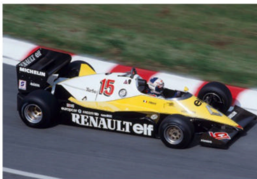
1983: LA RE40 LA RENAULT RE40 AFFICHE DE NOUVELLES TECHNOLOGIES: COQUE LÉGÈRE, DISPOSITIF ANTI-TEMPS DE RÉPONSE DU TURBO, INJECTION D'EAU, SOUFFLAGE AÉRO. PROST DOIT S'INCLINER EN AFRIQUE DU SUD DEVANT PIQUET.
