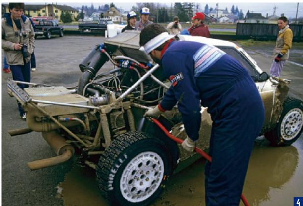
1 2 037から受け継がれたダブルウィッシュボーンサスペンション。長大なダンパーユニットで、グラベル戦でも十分なストロークを確保していた。3 4 複雑なツイン過給のパワーユニットとツインダンパーのサスペンションを037よりもコンパクトなリヤセクションに収めたデルタS4。ロンバルディが率いた技術陣の苦勞がしのばれる。
