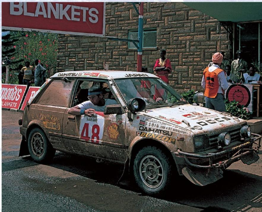
(上) 85年にダイハツはシャレードをベースに926ccSOHCターボエンジンを搭載したグループBマシンを発表(この排気量はターボ換算で1.3ℓクラスに編入され有利なため)、同年サファリでクラス優勝している。また東京モーターショーではデトマンがデザインしたボディをまとった「デトマン926R」が展示された(下)。DOHC化された120馬力の926エンジンをミッドシップに搭載して話題を呼んだが、結局市販はされず。
