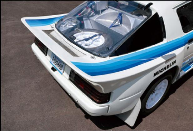
スキージャンプ台のような、独特な形状のリヤウイング（スポイラー？）に角度調整機能はなく、“羽根”を外せばオイルクーラーが姿を見せる。リヤダウンフォース確保は副産物で、こちらが主目的だった可能性も？
