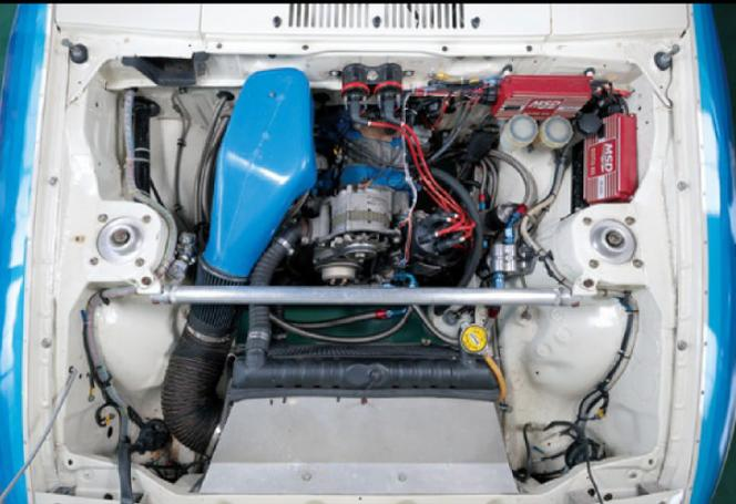
ロータリーらしくエンジンは驚くほど小さく低く、ラジエターとの空間も十分。結局7台しか生産されなかったという“エゴ”は市販車の12Aに替え13Bを搭載していた。市販車のセブンはすでにターボ付きロータリーエンジンは登場していたが、ラリーではノターボのままだった(300ps/8500rpm、270Nm/7500rpm)。MSDのイグニッションコントロールボックス(2基の赤い箱)は後年追加装着されたもの。
