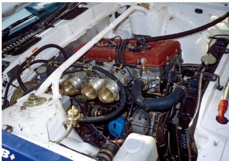
240RSのために専用設計された自然吸気の直4ユニット、FJ24。バルクヘッドに食い込むように搭載して重量バランスを最適化していた。初期の2365cc仕様で、265~270馬力を発生。
