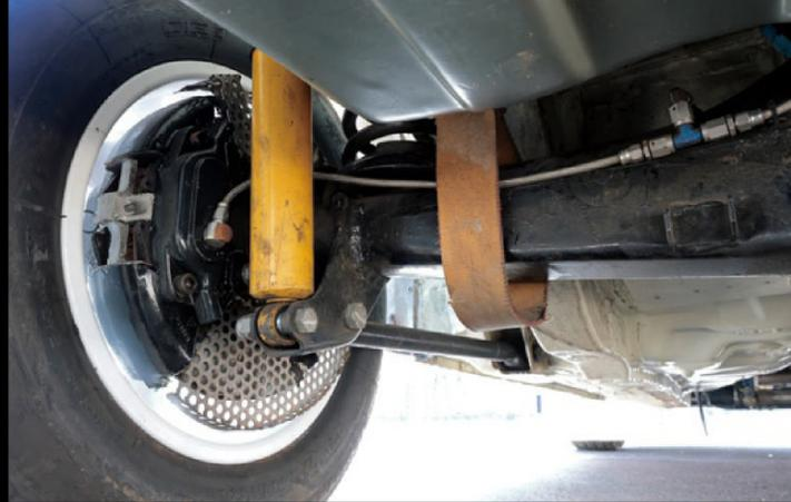
サスアームにはハイジャンプ時にアシが伸びて逆位相に垂れたまま着地することを防ぐためのバンドが巻かれ、ブレーキディスクには小石の噛み込みなど破損防止用のパンチ孔アルミカバーを装着。見えないところに実戦的な装備が。
