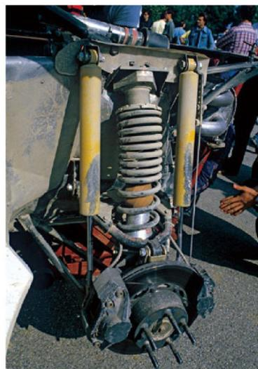
特徴のひとつであるツインショックのリヤサス。アップライトにかかる負荷を、ボールジョイントではなく強固なボディに直接伝える意図で開発された。
