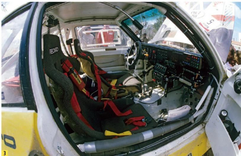
❶ウイングレットが付くリヤウイング。このタイプはグループBではオーディのみが採用。❷空力もS1 E2開発の大きなテーマ。フロントタイヤには整流のためのホイールカバーを装着することも多かった。❸シフトレバーにはクラッチを切るための油圧式スイッチが備わっていた。
