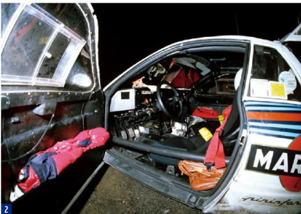
1 ランチアの市販車ラインナップから流用したのは、ベータ・モンテカルロのセンターモノコックのみ。2 ピニンファリーナの工房から、前後のフレームがない状態でアバルトへと納品。そこにパイプフレームが追加された。
