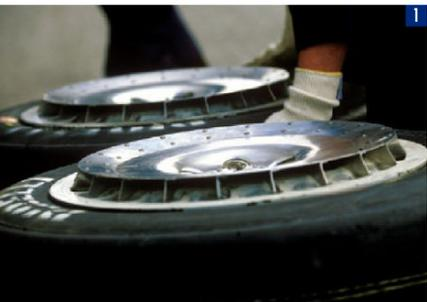
1 ターマックではエアベンチレーター付きのホイールを採用。後年のグループAデルタにも引き継がれたアイデアだ。2 ふたつのインタークーラーへの冷却風は、ボディサイド後部に設けられたエアインテークから導かれる。
