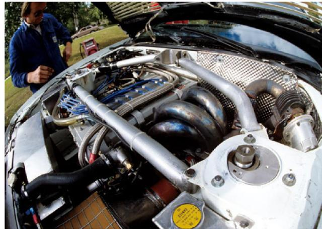
3T-GTをベースにボアを広げてハイパワーを求めた4T-GTエンジン。エボリューションモデルはKKK製ターボチャージャーを装着する。
