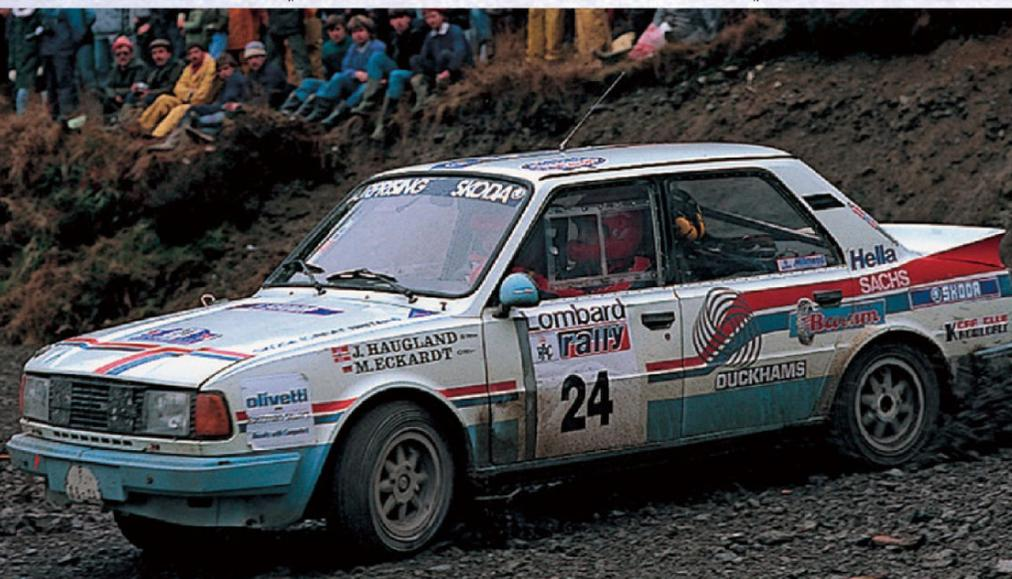
モータースポーツに熱心だった東欧シュコダのグループB車が130 LR。1.3ℓ OHVエンジンをリヤに搭載するRR車だ。その後も彼らの小排気量クラスでの参戦と奮闘は続き、現在はVWグループの一員として積極的にプライベート向けマシンを開発、供給して各地の選手権を支えている。
