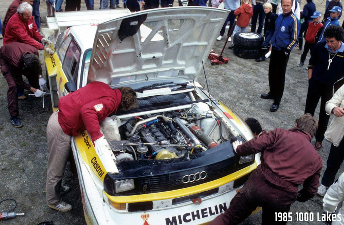
S1 E2のエンジンは公称550馬力。だが実際には常時600馬力以上を発生していたとされる。ターボにはアンチラグシステムも装備、そのほかにも電子制御センターデフ採用やギヤシフトにボルシェのPDKシステムを試験採用するなど、先進的な取り組みが多かった。
