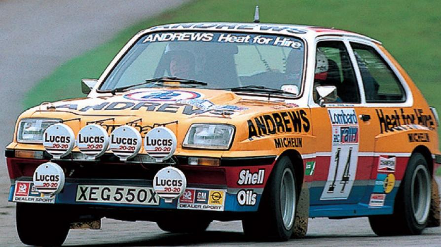
オペルの英国ブランドであるボックスホールが投じたグループ4ベースのFRマシンがシェベット。2279ccで250馬力を発生する直4エンジンを搭載する。もともとは70年代に北米でシボレーが開発、販売していたコンパクトカーだ。写真の14号車はラッセル・ブルックスが駆った一台で、83年のRACで5位フィニッシュを果たしている。
