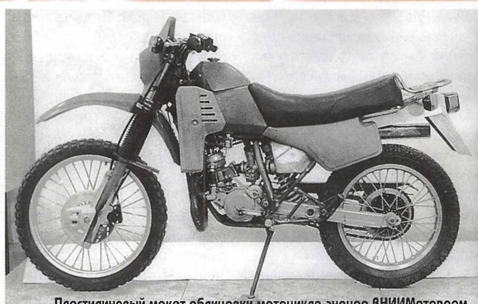
Пластиновый макет облицовки мотоцикла-эндуро ВНИИМотопром.
