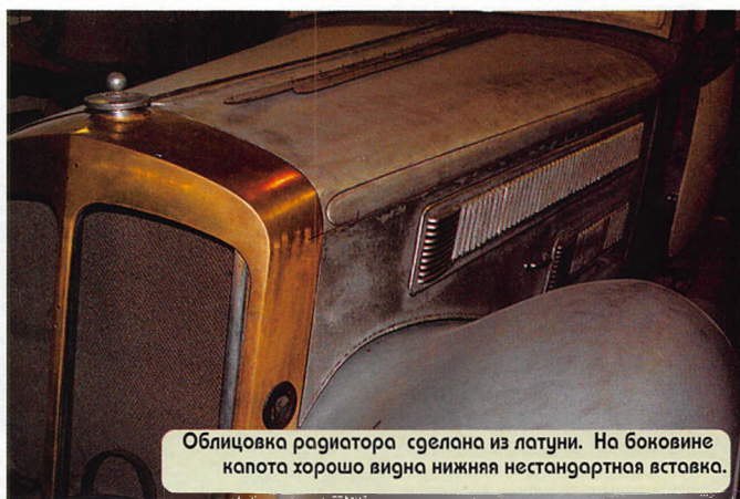
После отмывки водой под давлением на передней панели обнаружилось не только все заводские таблички, но и оригинальная краска.
