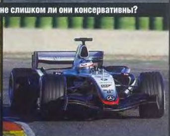
McLaren-Mercedes MP4-20: по-прежнему привержены двухкилевой концепции, надеются развить прошлогодний успех
