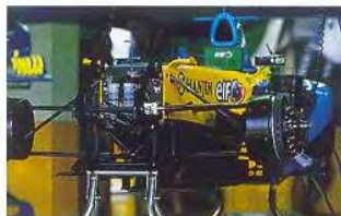
V-образный киль – рычаги подвески R26 смонтированы на треугольном киле
