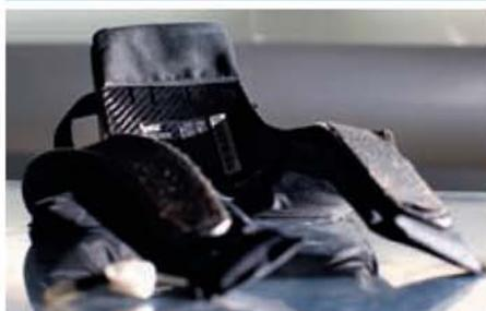
Apparu en 2003, le système HANS (Head And Neck Support) posé sur les épaules permet d'éviter les fractures au cou.
