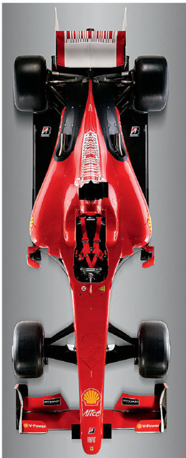
La différence entre la partie arrière de la Ferrari F399 de 1999 et celle de la F2009 de l'an dernier est particulièrement visible sur cette vue de haut. Le resserrement dit "façon bouteille de Coca" s'est fait de plus en plus extrême au fil des années. La raison d'être de ce design est de faire en sorte de gérer au mieux les turbulences dues aux roues arrière pour assurer de meilleures performances du dessous et du diffuseur.
