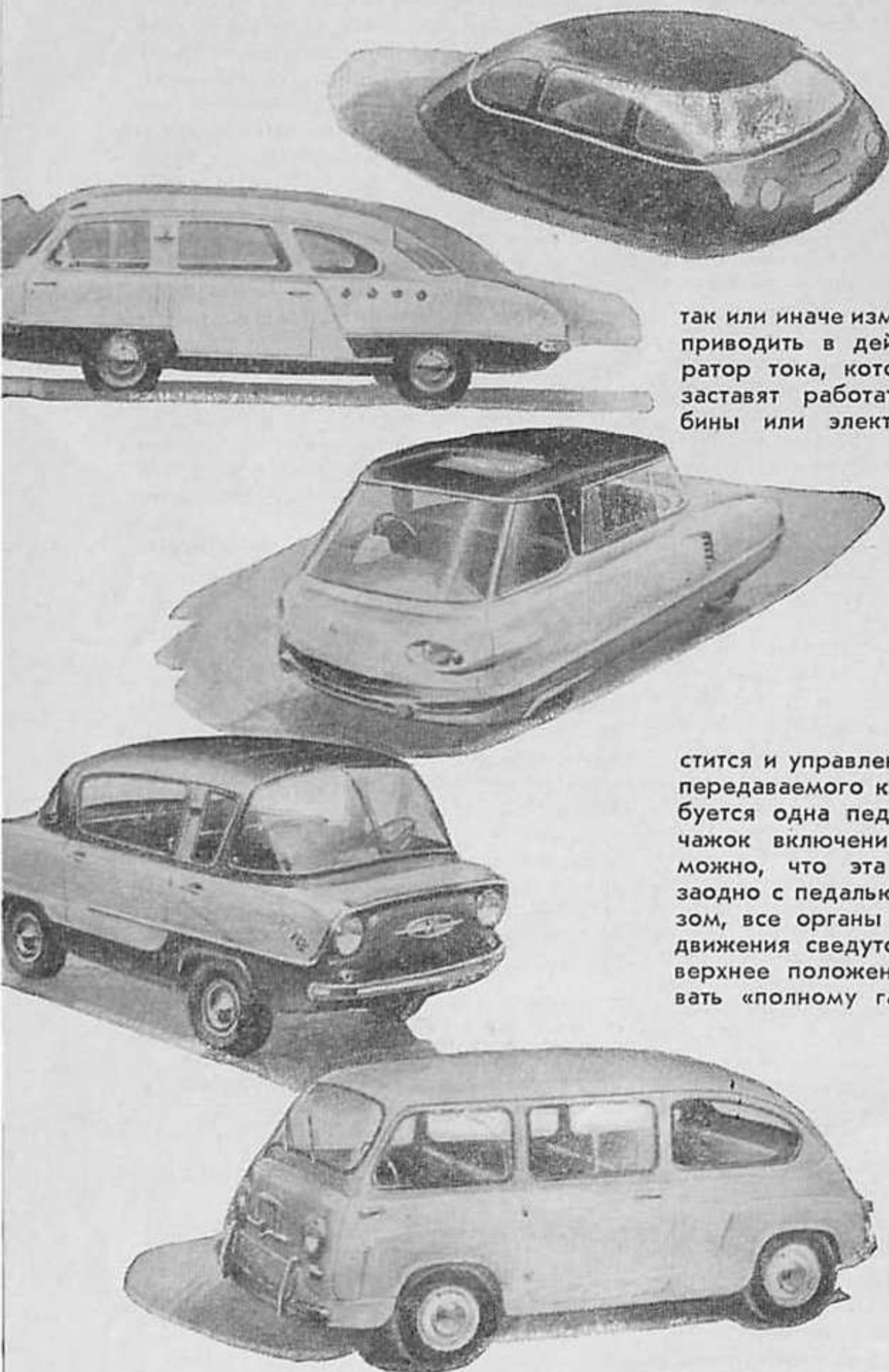
Сверху вниз: опытный автомобиль Шлер (Германия, 1940 г.); опытный советский автомобиль НАМИ-013, разработанный в 1949 г. и испытанный в 1952—1955 гг.; макет автомобиля «Турбокар», показанный в 1951 г. на Технической выставке в Англии; опытный советский малолитражный автомобиль «Белка» (1955 г.); автомобиль Фиат-600-Мультипла
