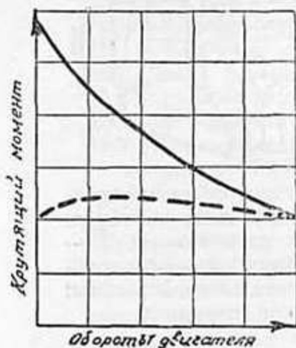
Рис. 3. Характеристики крутящего момента двухвального газотурбинного двигателя и поршневого
