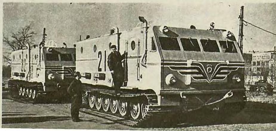
Советские тягачи-гиганты высокой проходимости, созданные харьковскими машиностроителями для исследовательской работы в Антарктиде. Длина машины — 8 м, ширина — 4 м, вес — 34 т, ширина гусеницы — 1 м.
