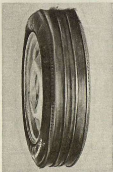
Рис. 5. Монтаж шины модели М-75. На накаченную, находившуюся на ободе шину (а) надевают сначала центральное (б), а затем крайние протекторные кольца (в).
