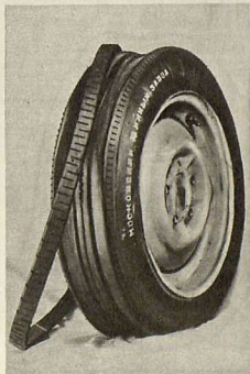
Рис. 5. Монтаж шины модели М-75. На накаченную, находившуюся на ободе шину (а) надевают сначала центральное (б), а затем крайние протекторные кольца (в).
