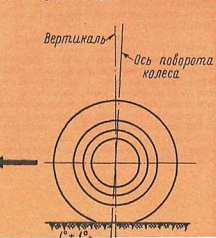
Рис. 4. Угол продольного наклона оси поворота колеса.
