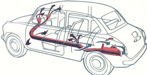
Рис. 5. Схема отопления автомобиля «Запорожец» отопителем, работающим независимо от двигателя. Теплый воздух подается в переднее и заднее отделения кузова и на ветровое стекло. Отопитель может также использоваться для предпускового подогрева двигателя.
