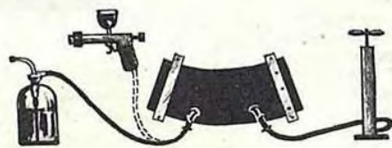
Рис. 2. Устройство для окраски.
