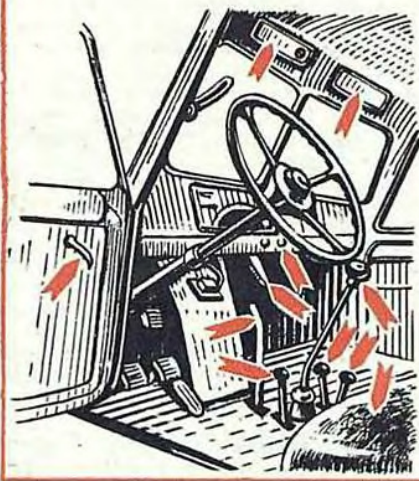
Рис. 3. Детали и поверхности автомобиля, подвергаемые частичной дезактивации.
