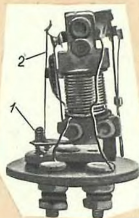
Рис. 3. Реле РС-57: 1 — винт; 2 — тепловой элемент.
