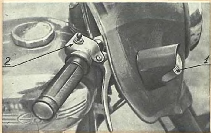
Рис. 1. Передний указатель поворота на ветровом стекле мотоцикла: 1 — фонарь правого указателя; 2 — переключатель.
