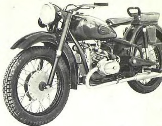
Экспериментальный ирбитский мотоцикл с резиновой торсионной подвеской.
