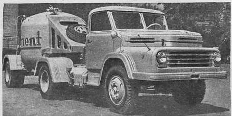
Цементовоз грузоподъемностью 7 т.
