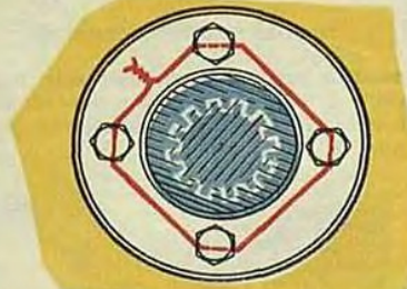
Рис. 2. Болты фланца карданного шарнира лучше крепить проволокой.
