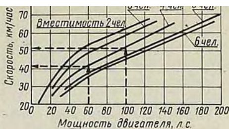
График для выбора параметров глиссирующих судов.
