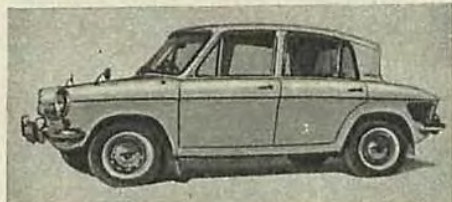
«Мазда-600» с четырехцилиндровым двигателем мощностью 28 л. с. Вес 585 кг. Скорость 105 км/час.
