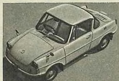
Купе «Мазда-360» с двухцилиндровым двигателем 16 л. с.; принудительное воздушное охлаждение. Независимая подвеска всех четырех колес. Вес — 395 кг. Скорость — 90 км/час.
