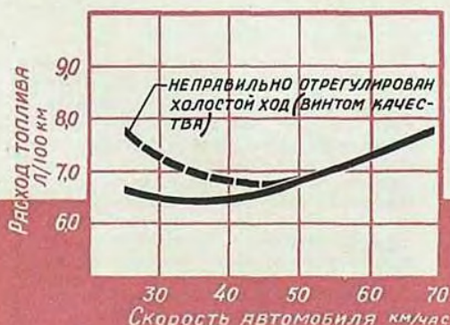
Рис. 5. График зависимости расхода топлива у «Москвича-407» от скорости при движении на прямой передаче. Сплошная линия — правильная регулировка; пунктирная — неправильная.
