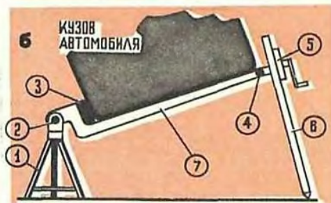
Рис. 3. а) Автомобиль на трехопорном связанном опрокидывателе. б) Схема устройства опрокидывателя: 1 — подставка; 2 — пальцы; 3 — упоры; 4 — шарнир; 5 — каретка; 6 — направляющие; 7 — рама.
