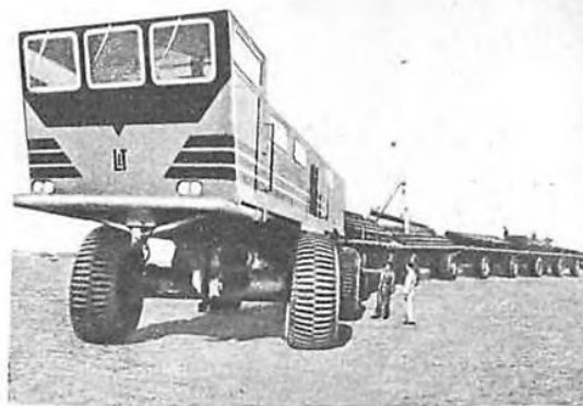
Автопоезд, состоящий из головного вагона и пяти двухосных прицепов.
