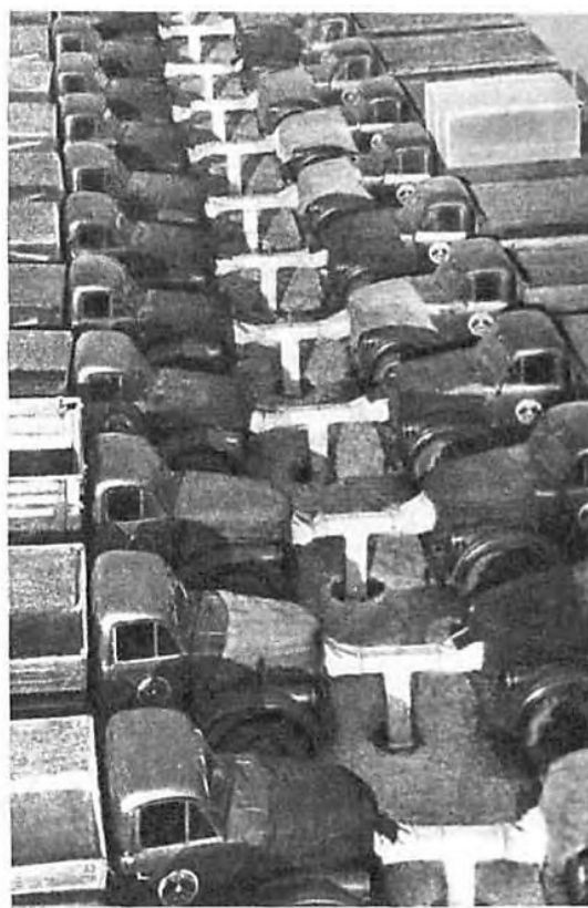
Безгаражная стоянка автомобилей, оборудованная воздухоподогревом.
